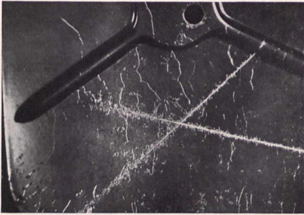
Bild 3. An lackierten Eisenteilen treten bei Tropenbeanspruchungen häufig aderförmig verlaufende Unterrostungen auf
