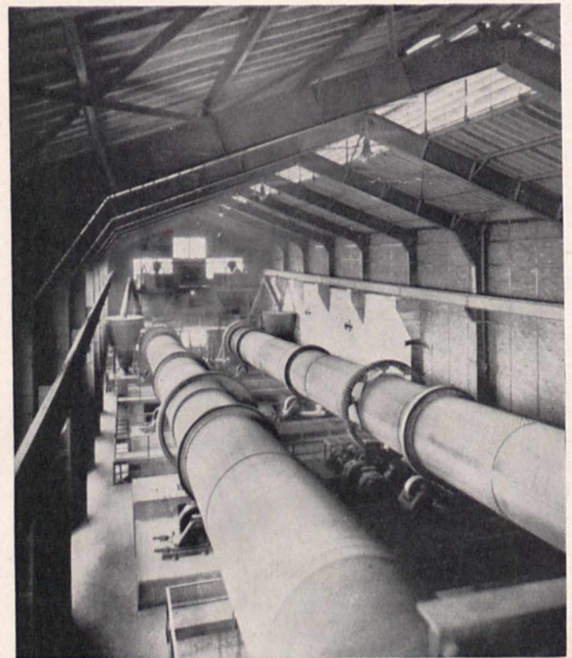
Bild 4. Drehofen zur Herstellung von Portlandzement aus Hochofenschlacke und etwas Kalkstein
