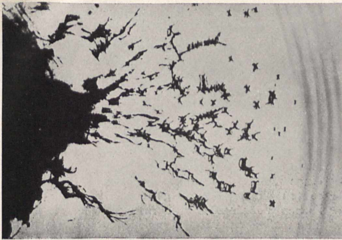
Bild 5. Zertrümmerung einer Glasplatte durch die Detonation eines Sprengstoffes. Die Front der durch die Detonation im Glas ausgelösten Schallwellen ist am rechten Rande des Bildes sichtbar. Bilder 1, 4, 5; Schardin
