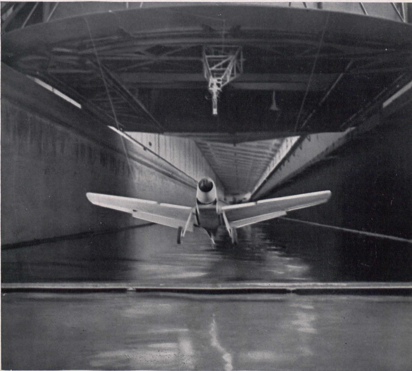
Modell eines Träger-Jagdflugzeuges bei der Wasserung
