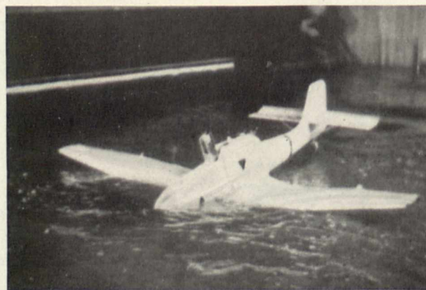
Bild 9. Notwasserung eines Trägerflugzeuges mit eingefahrenen Rädern. Es tritt nur noch ein leichtes Anheben des Schwanzes ein
