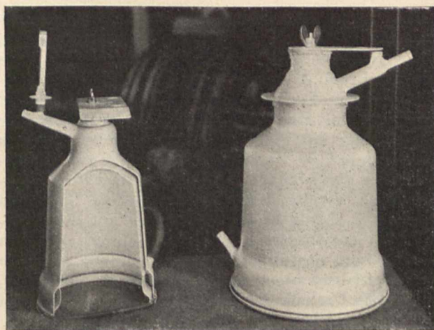
Bild 6. Moderner Warm-Entkeimungs-Apparat für Süßmoste im Schnitt und von außen. Im engen Hohlraum steigt der Saft hoch. Der Apparat hängt im beheizten Wasserbad Alle Bilder: Baumann
