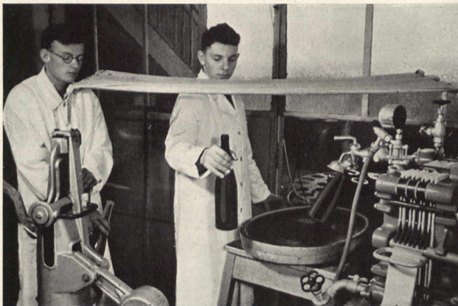
Bild 4. Kalt-Entkeimung von Süßmost durch den Bakterienfilter (rechts) Die Tuchbahn schützt vor Nachinfektion beim Weg zur Korkmaschine
