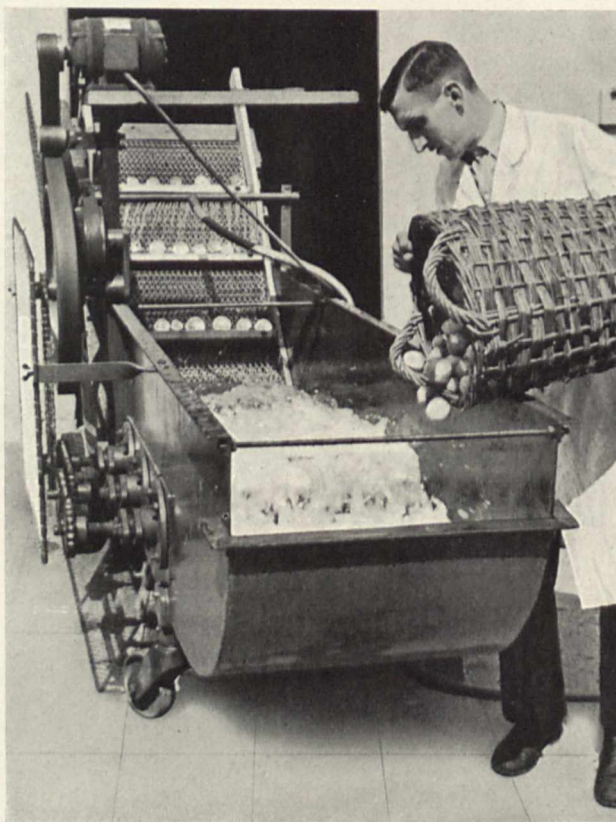
Bild 1. Die Waschmaschine, deren Bürsten unter Wasser laufen, reinigt das Obst
