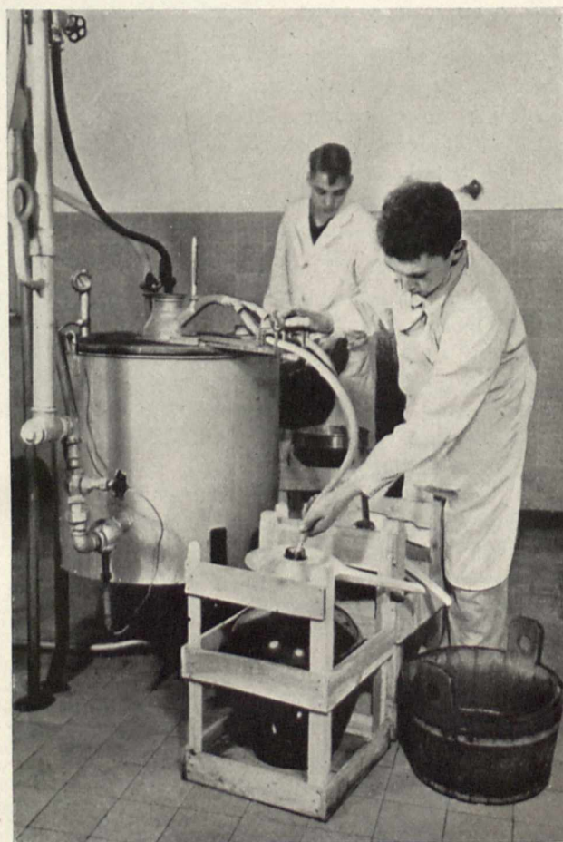
Bild 5. Warm-Entkeimung unter Luftabschluß nach dem Rapid-Verfahren (Erhitzung unter Luftabschluß im Lauf einer Drittel Minute)
