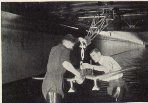
Bild 2. Ein Modell wird am Führarm des Versuchswagens eingehängt
