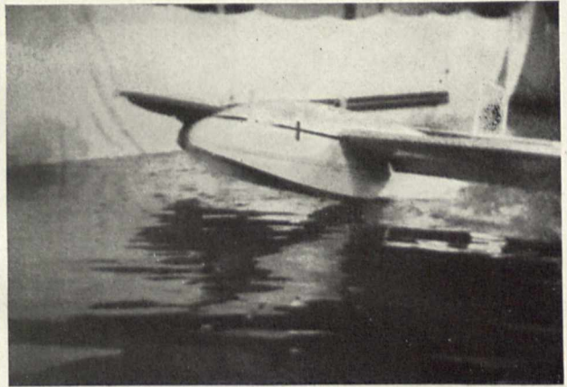
Bild 11. Wasserung eines normalen Flugbootes. Der Gleitweg ist wegen des geringen Widerstandes vergleichsweise der längste
