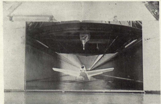
Bild 12. Wasserung eines Träger-Jagdflugzeuges im Modellversuch
