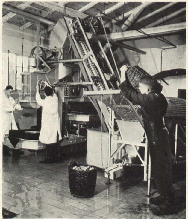
Bild 3. Moderne Packpresse mit Trommel-Waschmaschine und Becherwerk für das Obst, hochgebaute Mühle und schwenkbaren Bieten (Die eine wird gefüllt, die andere ist unter Druck zu sehen)
