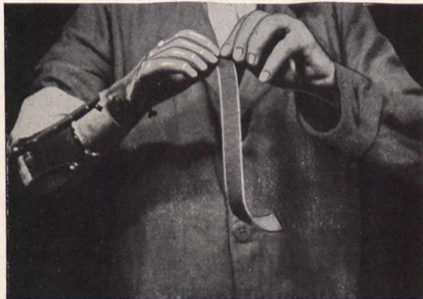
Bild 5. Als Lagerist Ausgabe von Schmirgelpapier, das er in Streifen reißt. Die rechte Lange-Hand hält und reißt
