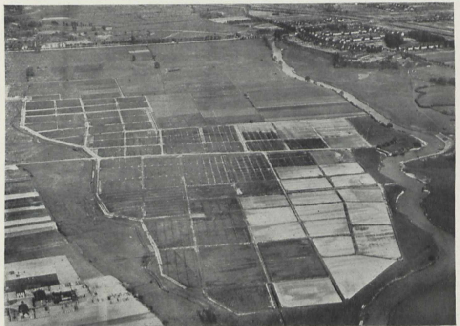
Bild 7. Rieselfeldanlage zur natürlich biologischen Abwasserreinigung
