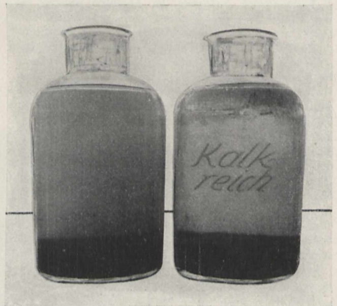
Bild 3. Kalkarmes und kalkreiches Wasser, mit derselben Schlamm-Menge aus dem Großen Plöner See angesetzt und umgeschüttelt, sodann der Ruhe überlassen. Nach 5tägigem Stehen wurden die beiden Flaschen photographiert. Während der aufgewirbelte Schlamm in dem kalkarmen Wasser in der Schwebe blieb, sedimentierte er unter den kalkreichen Bedingungen der zweiten Flasche nach kurzer Zeit gänzlich, so daß die Lösung klar wurde. Eine hinter der Flasche angebrachte Schrift ist deutlich lesbar. Sie ist im Gegensatz dazu bei der ersten Flasche gar nicht zu erkennen
