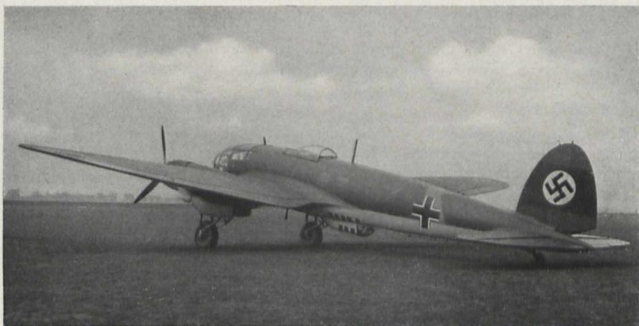
Bild 2. Das gleiche Flugzeug schräg von hinten gesehen. Stand des Heckschützen und die Bodenwanne sind gut erkennbar
