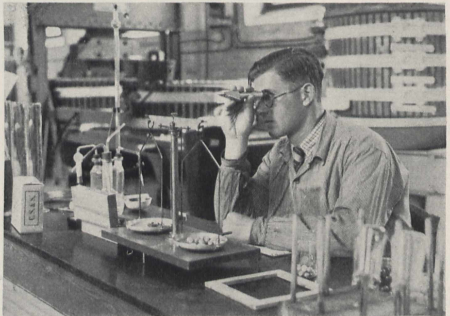
Bild 1. Arbeitsanordnung bei der Reifekontrolle. Die in Glasbechern gesammelten Beeren werden gezählt, gewogen und anschließend einzeln gemessen. (Tägliche Einzelbeerenuntersuchungen)
