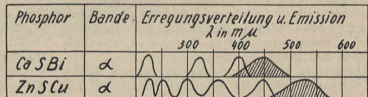
Erregungs- und Emissionsbanden zweier in Leuchtnadeln verwendeter Phosphore
