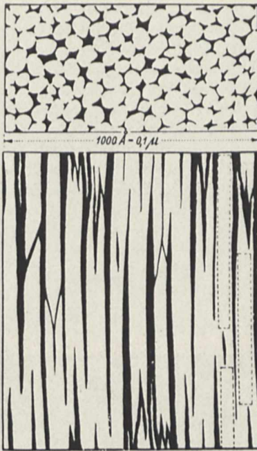
Bild 7. Submikroskopisches Mizellargerüst in der Zellwand einer Bastfaser. Oben Querschnitt, unten Längsschnitt, nach Frey-Wyßling (7, 10)
