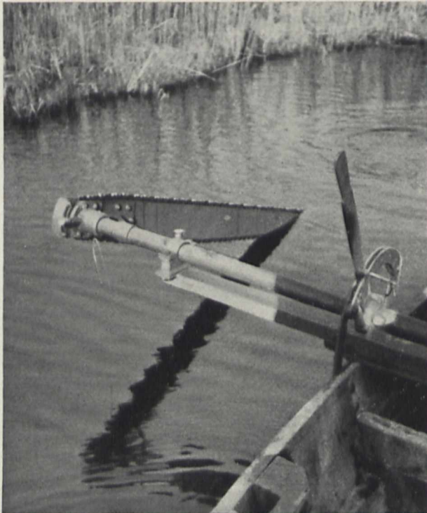
Bild 1. Das Pflanzengewirr am verlandeten Ufer wird mit der Motorsäge zerschnitten
