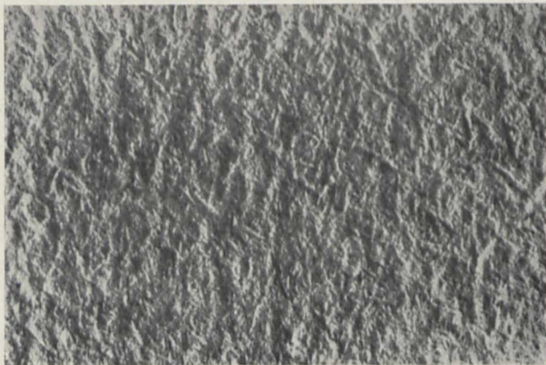
Bild 1. Die Schreibpapieroberfläche zeigt bei starker Vergrößerung die Rauigkeiten, an denen sich die Federspitze abnützt
