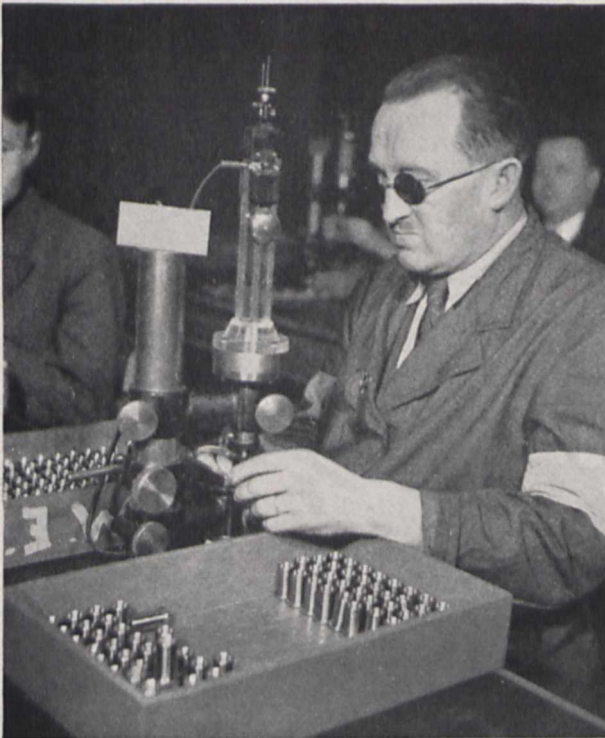
Bild 1. Spezialmeßgerät für Blinde. Das akustische Zeichen wird auf Kopfhörer übertragen. Durch Anwendung des Kopfhörers wird eine Beeinträchtigung der in der Umgebung sitzenden Arbeitskräfte vermieden
