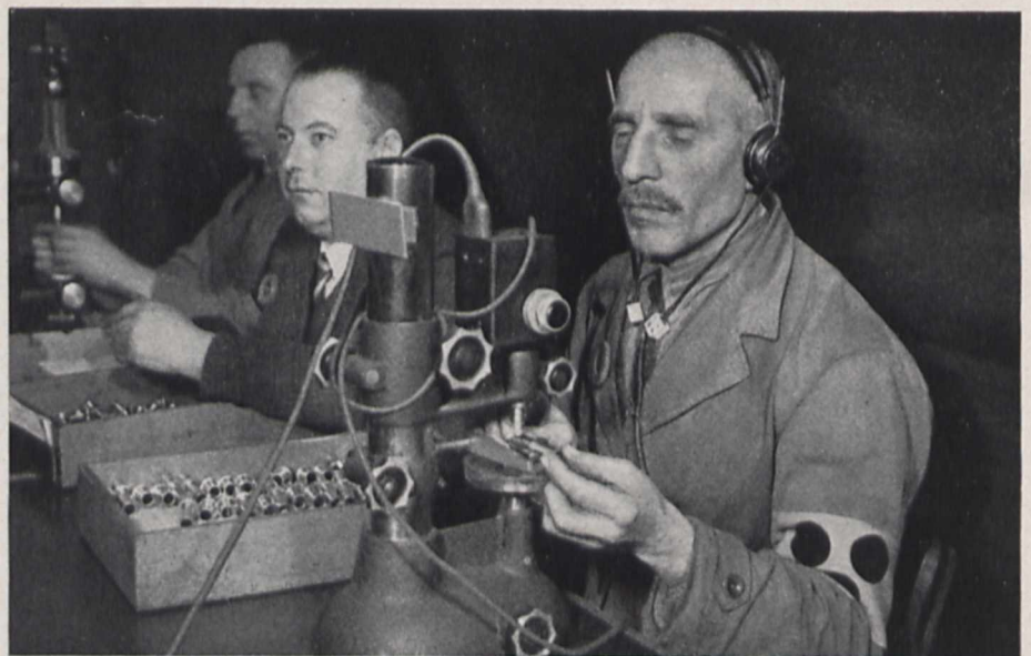
Bild 2. Blindenmeßapparat mit einer Genauigkeit von 1/1000 mm aus einer Werkstatt der Junkerswerke
