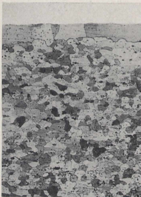
Bild 5. Schliffbild einer Plattierung von Reinaluminium auf Duralumin
