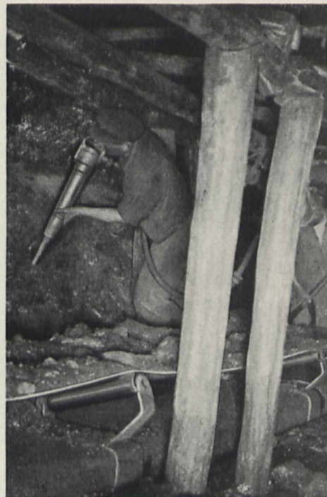
Bild 1. Bei der Arbeit mit dem Preßlufthammer. Die gelöste Kohle geht sofort auf die Rutsche
