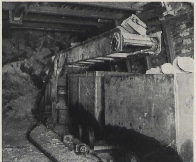
Bild 3. Der Ladewagen bringt größte Beschleunigung der Streckenvortriebs- und Querschlagsarbeiten
