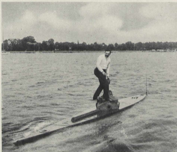
Bild 1. Versuchsboot „Forelle“, 16 t, auf Probefahrt in der Kieler Förde. Besatzung 3 Mann. Zwei außenbordsliegende 45er Torpedorohre. Baujahr 1902
