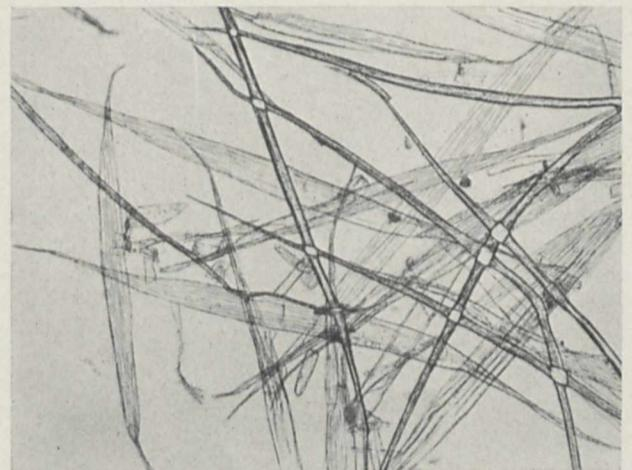
Bild 7. Zellstoff von einem Gemisch des Schirmbaumholzes und des Mangrovenholzes im Gewichtsverhältnis von 1 : 1 zeigt die breiten spindelförmigen Bänder der Schirmbaumfaser (entsprechend dem Frühholz), die schmalen zylindrischen Fasern der Mangrove (entsprechend dem Spätholz unserer Nadelhölzer)
