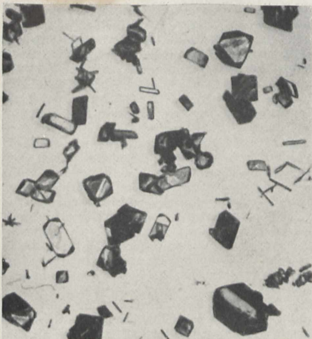
Bilder 5—7: Kristallwasserhaltiges Kodein beim Erhitzen Bild 5. Unter 60°
