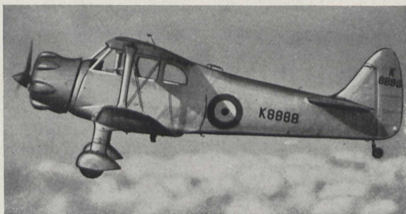
Bild 1. Ferngesteuertes, führerloses Kabinenflugzeug „Queen Wasp“ mit Fahrwerk
