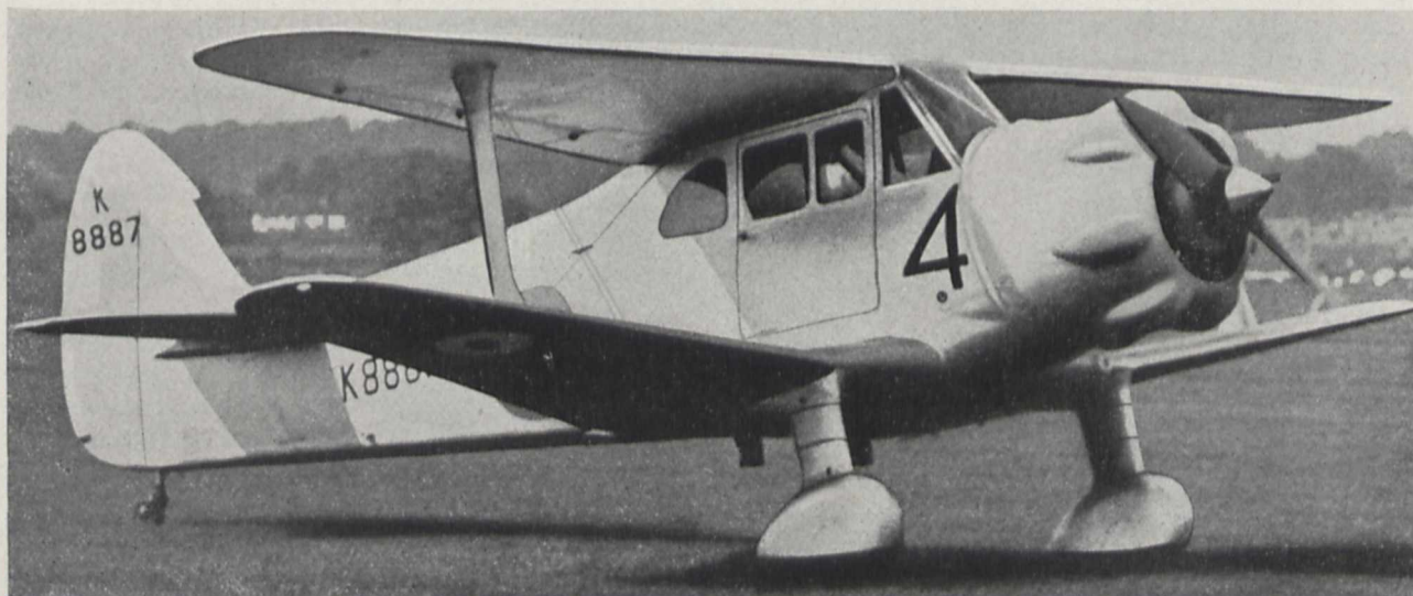
Bild 3. Funkgesteuertes Zielflugzeug Airspeed „Queen Wasp“ mit Armstrong Siddeley „Cheetah“-Motor
