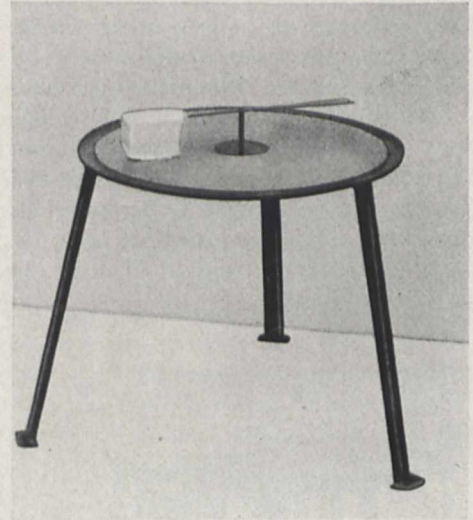
Bild 5. Eiablage-Uhr. In dem Gaze-Behälter am Ende des Zeigers sind legebereite Weibchen untergebracht
