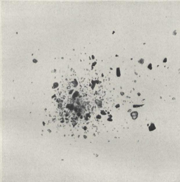
Bild 1. Probe einer geringen Staubmenge aus einem Aufschleuderungsgerät (Konimeter). Vergr. 142fach
