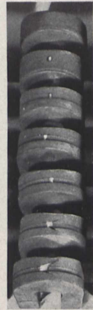
Bild 4. Biegeversuche mit dem neuen Silizium-Aluminiumberubigten Thomasstahl
