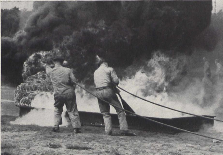
Bild 1. Brennendes Benzol wird durch Kohlensäureschnee gelöscht
