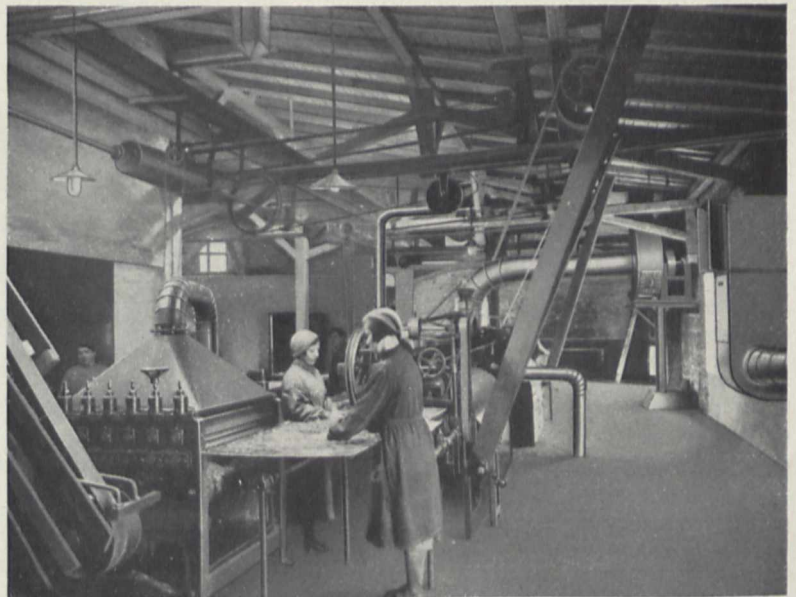
Bild 2. Entstaubung an Flachsauflbereitungsmaschinen
