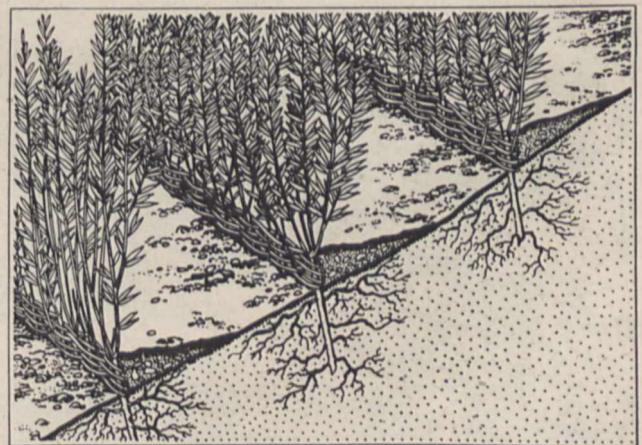
Bild 7. Der lebende Flechtzaun als Stützkörper von Erdmassen geht nach Austrieb der Weiden in den biologischen Schutz über
