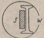
Bild 9 (links). Aufriß einer Eissprengung. S Sprengkörper; W Wirkungskreis, innerhalb dessen das Eis zerschlagen wird
