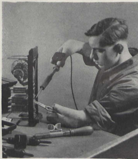
Bild 5. Weichlöten einzelner Verbindungen mit Lötkolben und Zange
