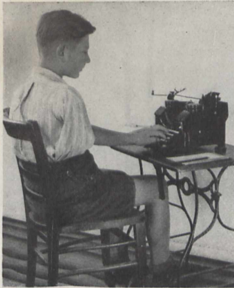
Bild 7. Einhänder benützt zum Umschalten der Schreibmaschine einen Kniebebel. Eine gut federnde Spirale verbindet diesen durch ein Loch in der Bodenplatte mit der Umschalttaste
