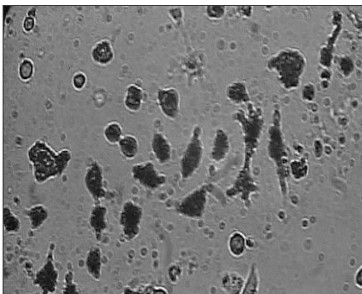
Rys. 123. Przykładowe wyniki badań działania cytotoksycznego próbek stałych pokrytych powłokami krzemionkowymi zawierającymi prekursor DEMS i VTES na linii komórek L929 po 24 godzinnej inkubacji. Widoczne liczne martwe, obkurczone i odklejone od podłoża komórki. Mikroskopia świetlna. Pow. 500×.
