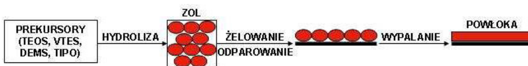
Rys.9. Procesy zachodzące w poszczególnych etapach otrzymywania warstwy metodą zol-żel [48].
