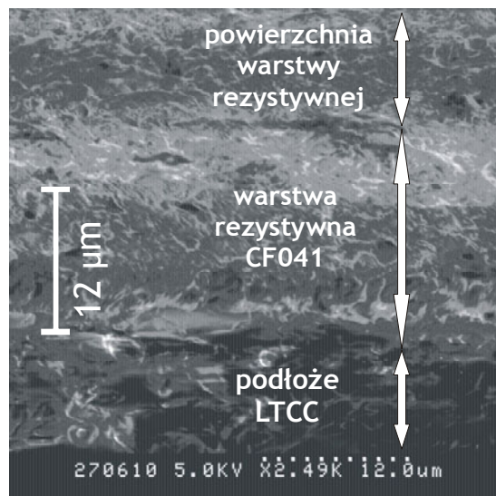
Rys. 3.7. Warstwa pasty CF041 na podłożu LTCC - powiększenie x2500
