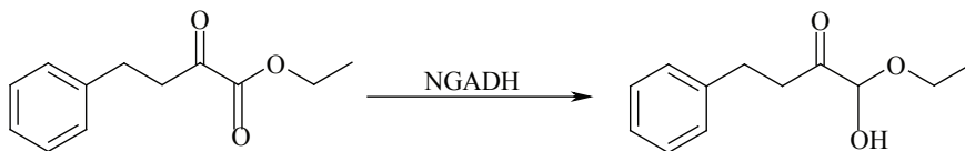
Rysunek 6. Redukcja 2-okso-4-fenylobutanianu etylu za pomocą NGADH
