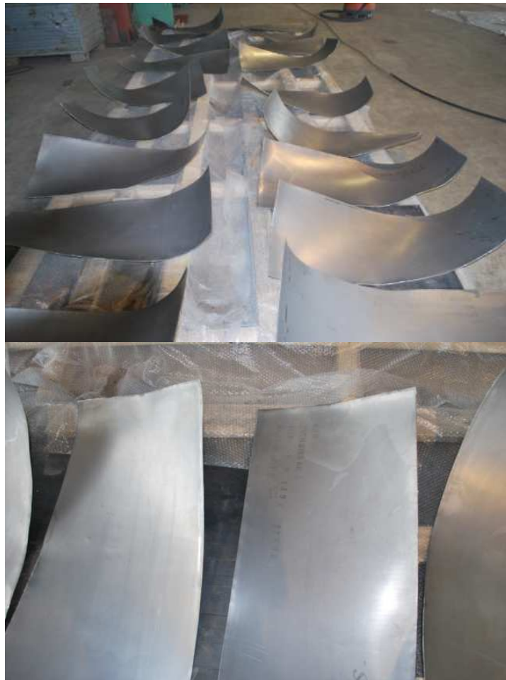
Rys. 62. Naprężenia własne w bimetalu tytan-nikiel
