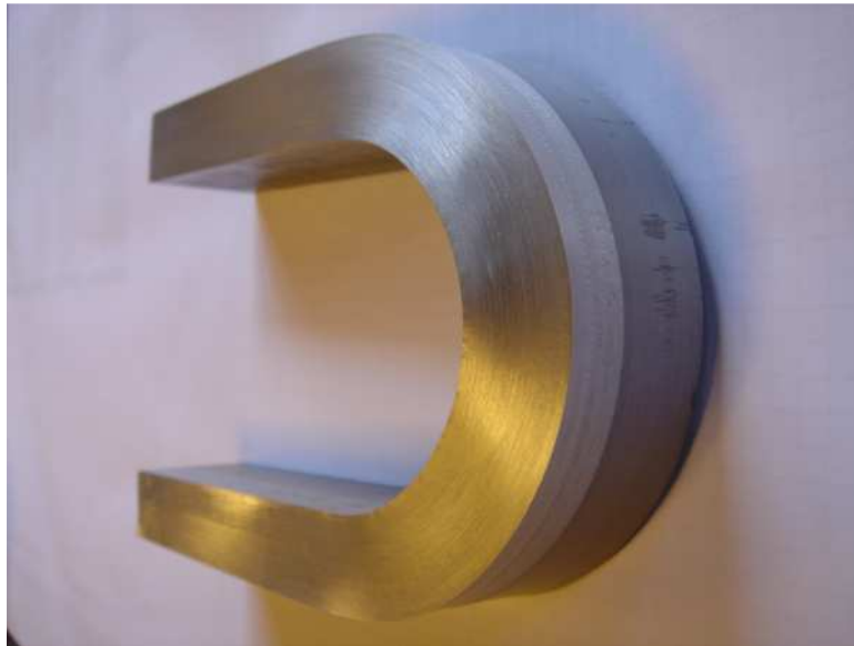
Rys. 16. Próbka po przeprowadzonej próbie zginania
