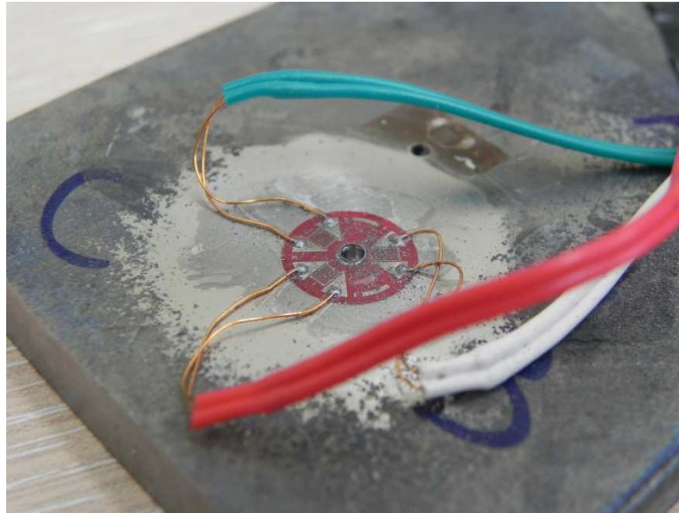
Rys. 74. Pomiar naprężeń własnych w blasze tytanowej
