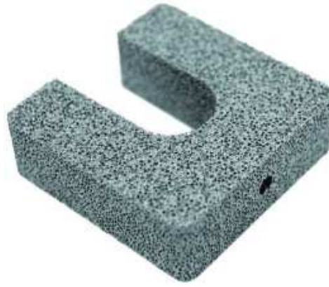
Rys. 31. Element wykonany z piany tytanowej [69]
