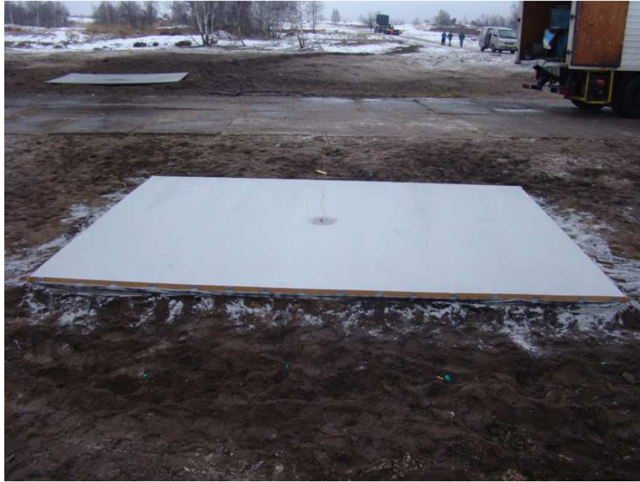
Rys. 7. Układ zgrzewania przygotowany do detonacji
