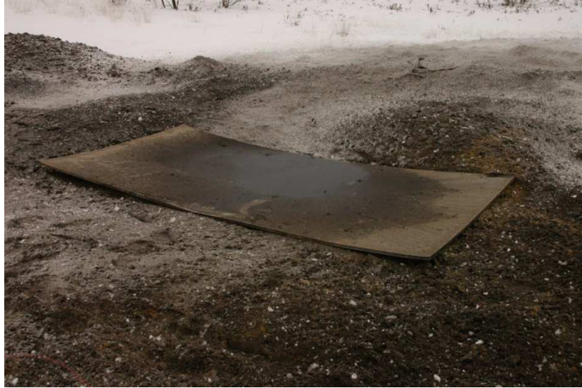
Rys. 79. Płyta bimetalu po detonacji materiału wybuchowego
