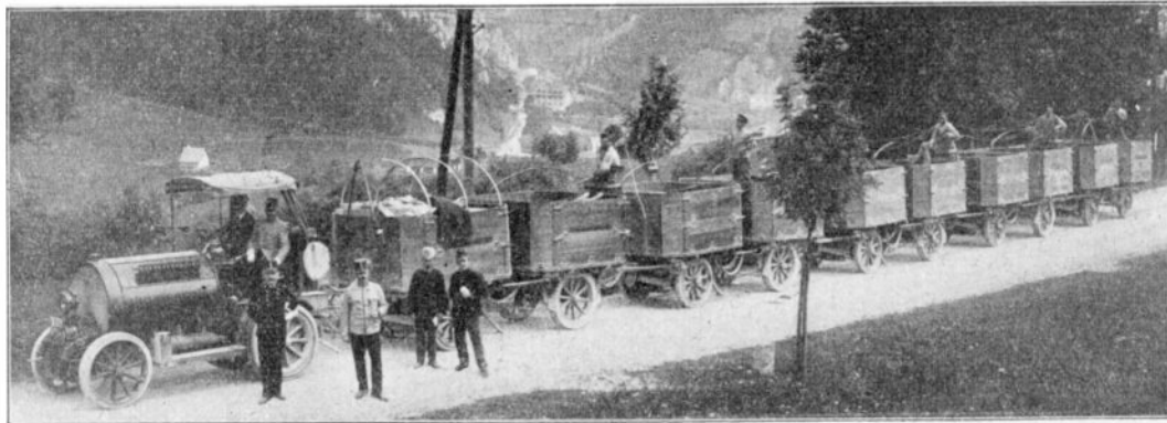
Abb. 6. — Generatorwagen mit 10 einachsigen, selbstangetriebenen Karren. (Oe. D. M. A.-G., Wr.-Neustadt.)
