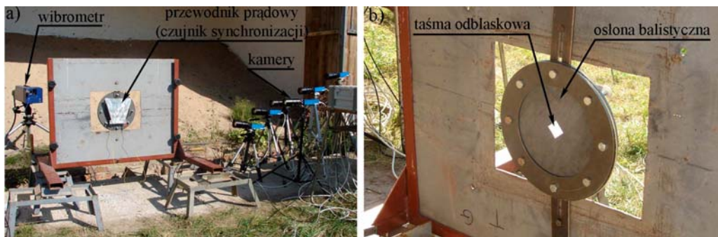
Rys. 9.21. Widok stanowiska do ostrzału osłony balistycznej: a) system rejestracyjno-synchronizacyjny, b) sposób oznaczenia skanowanej powierzchni, która została przestrzelona
