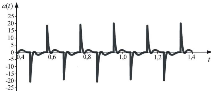
Rys. 6.37. Odpowiedź układu na wymuszenie prostokątne: a) postać graficzna prędkości, gdy i = 2 analizowanego układu (rys. 6.36), b) postać graficzna przyspieszenia, gdy i = 2 analizowanego układu (rys. 6.36)
