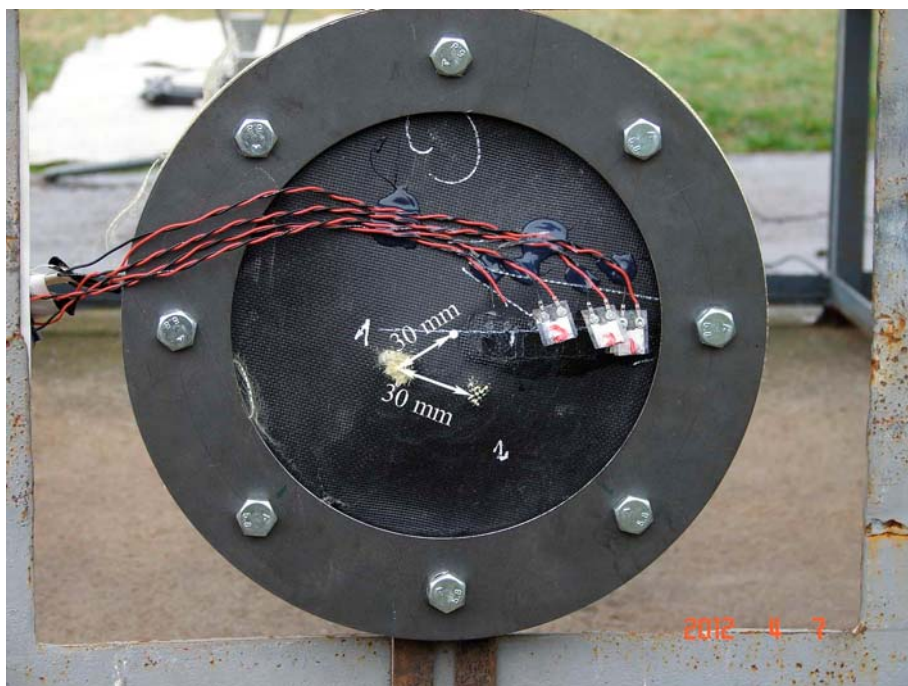
Rys. 9.33. Ostrzelana osłona z systemem pomiarowym czujników piezolaminatowych: strzał nr 1 – przestrzelenie osłony, strzał nr 2 – pocisk zatrzymany
