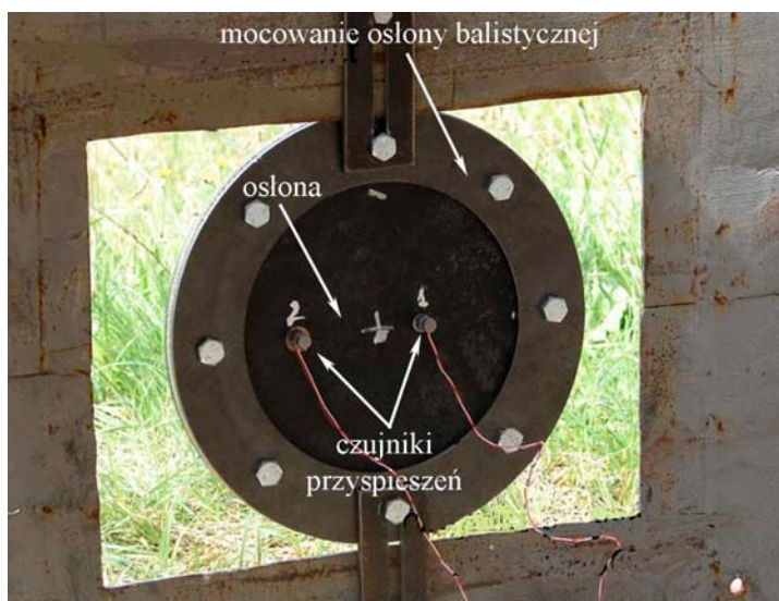
Rys. 9.32. Mocowanie czujników przyspieszeń w osłonie balistycznej
