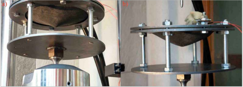
Rys. 9.18. Tworzywo po quasi-statycznym przebijaniu: a) widok z dołu stanowiska badawczego, b) widok z boku stanowiska badawczego
