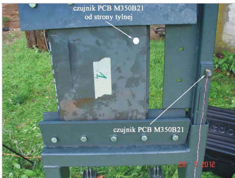
Rys. 7.13. Usytuowanie czujników pomiarowych w badaniach weryfikacyjnych wpływu zamocowania osłony na ruch całego układu
