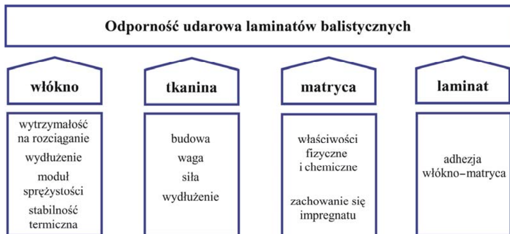
Rys. 2.7. Wpływ parametrów składowych na odporność udarową kompozytowej osłony balistycznej
