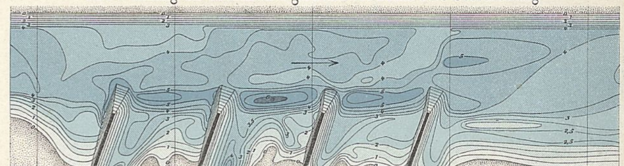
Abb. 7. Wirkung der stromabwärts gerichteten A-Buhne nach mäßiger Überströmung.
