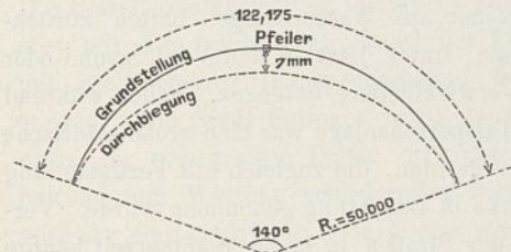
Abb. 26. Bewegung des Betonkerns des Staudammes für das Vorbecken.
