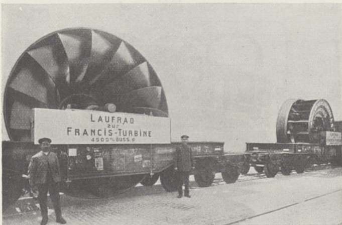
Abb. 6. Turbinenlaufrad auf dem Eisenbahnwagen.
