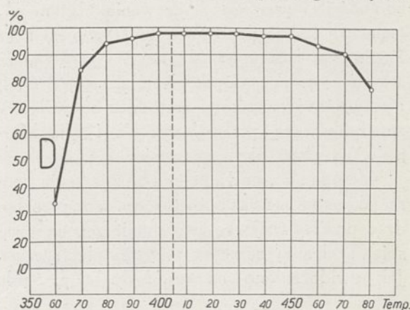
Rys. 6. Wytrzymałość na ścieranie brykietów z węgla koksującego D (zmienna temperatura).
