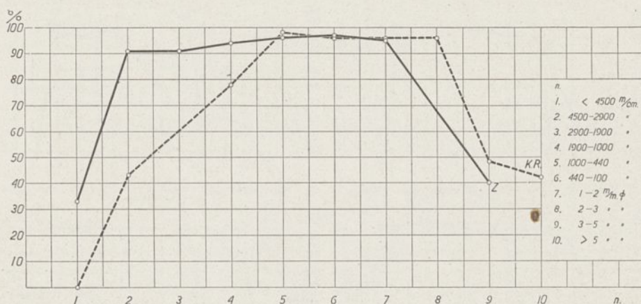
Rys. 18. Wytrzymałość na ścieranie brykietów z węgla niekoksującego (zmienna wielkość ziarna).
