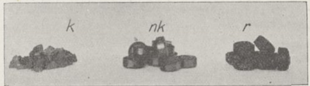
Rys. 10. Brykiety z węgla koksujących, niekoksujących oraz brykiety reprodukowane po próbie na ścieralność.
