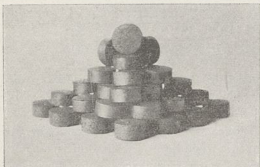
Rys. 19. Brykiety z węgla niekoksującego bez lepiszcza.
