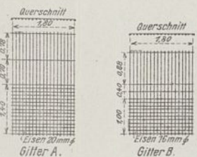
Abb. 9. Verstärkungsgitter in den Torpfeilern. 1:150.
