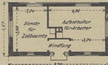
Abb. 78. Aufenthaltshaus auf der Mittelmauer.
