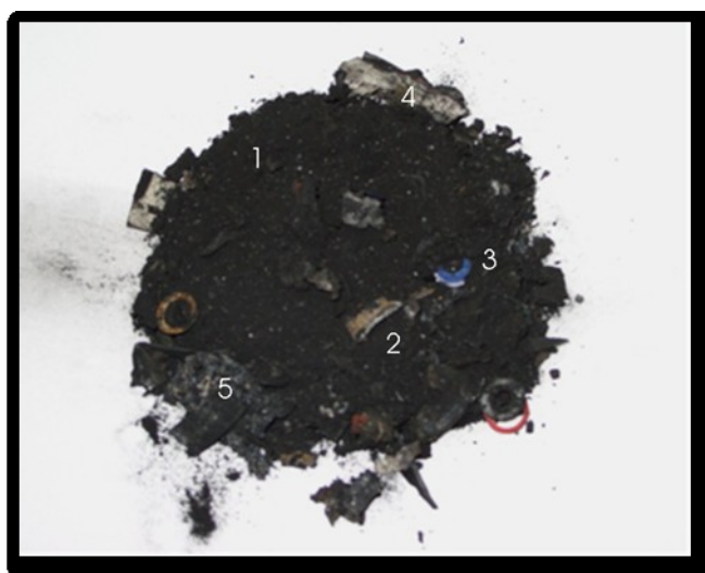
F_ 12. Frakcja paramagnetyczna. 1 - „czarna masa” bateryjna, 2 - polimerowe obudowy baterii, 3 - podkładki –polimerowe, 4 - kawałki papieru i tektury, 5 - elementy metalowe obudów.
