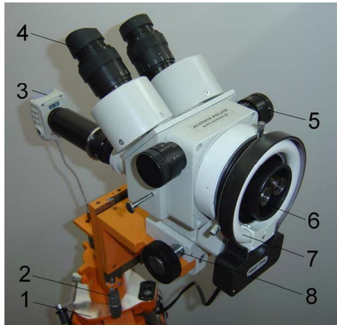
Rys. 4.11. Mikroskop z kamerą do pomiaru przyrostu pęknięć zmęczeniowych [78]: 1 – statyw, 2 – śruba mikrometryczna, 3 – kamera cyfrowa, 4 – okular, 5 – regulacja powiększenia, 6 – obiektyw, 7 – oświetlenie, 8 – regulacja ogniskowej
