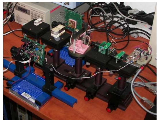
Rys.5.18 Schemat oraz realizacja układu do badania poszerzenia widma sygnału dudnienia laserów stabilizowanych częstotliwościowo metodą trzeciej harmonicznej
