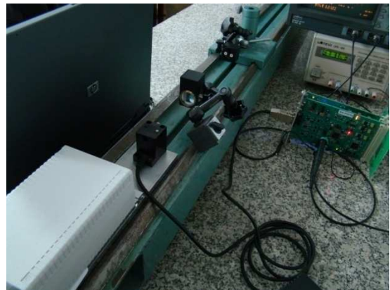
Rys.6.1 Schemat układu interferometru laserowego oraz jego realizacja
