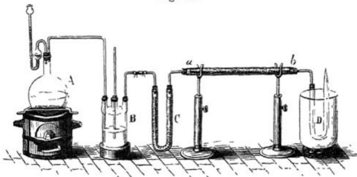
Umgeben der Röhre *ab* mit Eis oder kaltem Wasser vermeidet. Auch hierbei entsteht Chlorquecksilber und es entweicht ein orangegelb gefärbtes Gas, welches man in einer, mit einer Kältemischung umgebenen Röhre *D* zu einer Flüssigkeit verdichten kann. Es ist wichtig, dass die Temperatur während der Zersetzung sich nicht erhöht, da sonst die unterchlorige Säure sich vollständig zersetzen würde.
