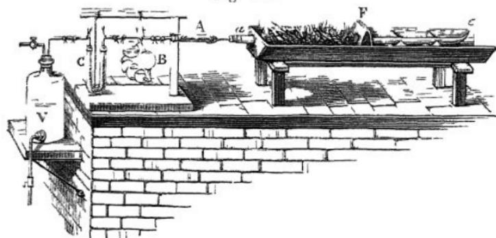
Kohlen, schützt dabei die hinteren Theile vor der Wirkung der Hitze durch einen Schirm *F* und rückt denselben, wenn das Kupferoxyd vorn glüht, allmählig nach hinten, so dass auch die Mischung der organischen Substanz mit dem Kupferoxyd zum Glühen kommt und verbrennt. Das Wasser verdichtet sich in
