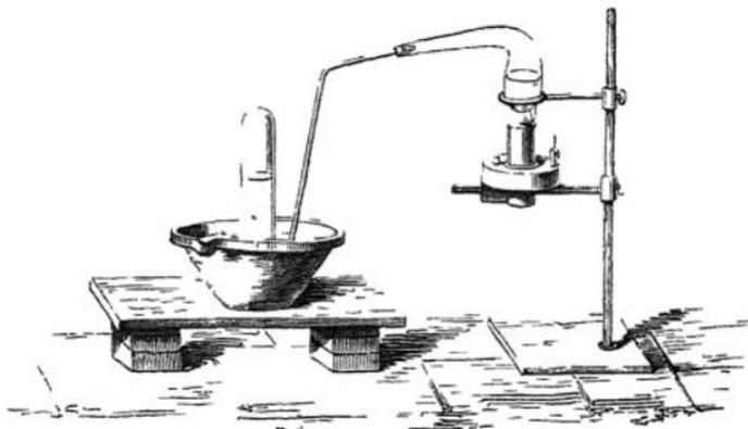
setzen anfangt, eine Menge von Gasblasen und wird dabei allmählig immer dickflussiger, fast teigartig, wenn man alsdann nicht starker erhitzt, so hört die Entwicklung von Sauerstoff auf. Gegen das Ende der Operation muss man Acht haben, dass der Boden der Retorte, welcher besonders der Hitze ausgesetzt und häufig ganz entblösst ist, nicht die Temperatur annimmt, in welcher das Glas weich wird; er würde sich sonst aufblähen und die Operation misslingen.
