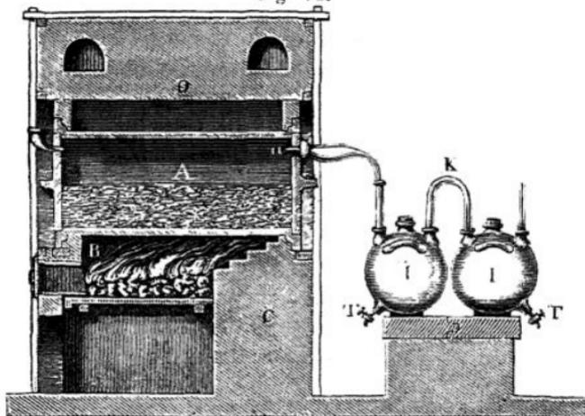
horizontal in Oefen eingemauert hat. Das beim Erwärmen entweichende Gas begiebt sich durch die Röhre *a* in grosse Flaschen *I* von Steinzeug, welche ähnlich wie Woulff'sche Flaschen eingerichtet und etwa zur Hälfte mit Wasser angefüllt sind. Der Rückstand in den Cylindern, das schwefelsaure Natron, ist das Hauptproduct des Processes, während die Chlorwasserstoffsäure hierbei nur als Nebenproduct gewonnen wird.
