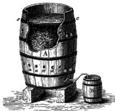
Anzahl von Löchern *a*, sowie oben eben solche *b*, wodurch ein fortwährender Luftwechsel bedingt wird. Am oberen Theil des Fasses ist ferner ein siebförmiger Boden *cde* angebracht, wodurch der Alkohol in Tropfen zertheilt auf die Holzspäne fliesst und allmählig bis auf den Boden des Fasses rinnt. Die Holzspäne werden zuerst mit Essig getränkt, wodurch sie in einen Zustand von Verwesung übergehen, welcher die Oxydation des Alkohols vermit-
