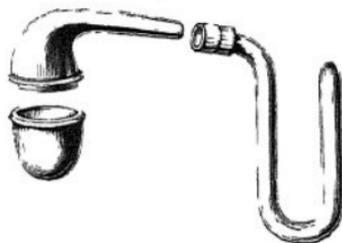
ihrer Darstellung Platin- oder Bleigefässe anwenden muss. Der gewöhnlich in den Laboratorien angewendete Apparat besteht aus einer bleiernen Retorte (Fig. 56), welche aus zwei auf einander schliessenden Theilen zusammengesetzt ist. Der untere Theil hat die Form eines Tiegels, er enthält die Mischung;
