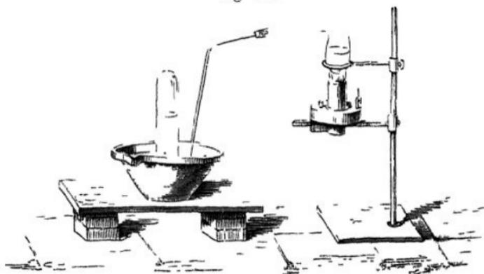
Gasleitungsröhre versehen ist; das Salz schmilzt anfangs ruhig, entwickelt hierauf eine Menge von Gasblasen, die man entweder über Quecksilber oder über Wasser auffängt, und in dem Hals der Retorte scheidet sich Wasser ab. Man muss hierbei das Feuer der Spirituslampe so weit mässigen, dass keine zu rasche
