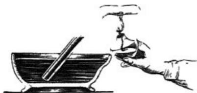
Momente der Zersetzung muss man die Rohre fest in der Hand halten, weil sie sonst in Folge der Explosion aus der Wanne geschleudert werden konnte. Nachdem die Rohre erkaltet ist, bringt man das Gas in die frühere graduirte Glocke zurück und sieht leicht, dass das Volum desselben in Folge der Zersetzung nicht abgenommen hat. Es ergibt sich hieraus, dass das Stickstoffoxydulgas sein gleiches Volum Stickstoff enthält.
