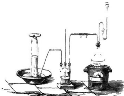
und setzt durch die S-förmig gebogene Röhre allmählig Chlorwasserstoffsäure zu. Man erwärmt mit ein paar Kohlen, um die Entwicklung zu beschleunigen. Das Wasser der Waschflasche hält die mit übergehende Chlorwasserstoffsäure zurück.
