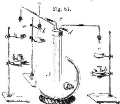
tet man 1) schwefelige Säure, die man im Kolben *a* aus concentrirter Schwefelsäure und Kupfer entwickelt; 2) Stickstoffoxydgas, in dem Kolben *b* durch Einwirkung von Salpetersäure auf Kupferdrehspähe bereit; 3) Wasserdampf aus dem Kolben *c*.
