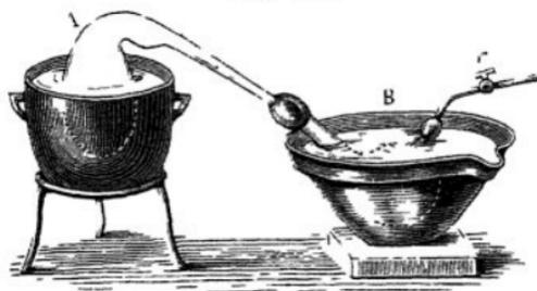
bindung steht und mit Siegelack luftdicht daran befestigt ist. In dem Tubulus wird eine mit einem Hahn versehene Bleirohre luftdicht befestigt, welche mit der Luftpumpe in Verbindung steht.
