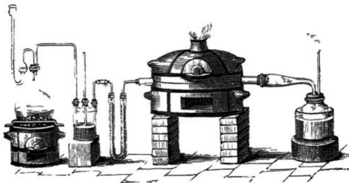
deren eines Ende mit einem Apparate in Verbindung steht, welcher einen Strom von getrocknetem Chlorgas liefert, während das andere Ende mit einer gut abgekühlten Vorlage verbunden ist, worin das Chloraluminium sich in Gestalt kleiner, gelblich-weißer, krystallinischer Blattchen verdichtet. Das Chloraluminium ist sehr flüchtig und verbreitet an der Luft dicke Nebel; es zieht rasch Feuchtigkeit aus der Luft an.
