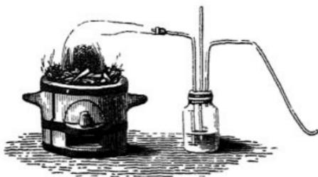
gepulvertem Manganhyperoxyd und 1 Thl. Schwefelblumen, und leitet das Gas zuerst durch eine kleine Waschflasche, um es von ein wenig in der Hitze verdampftem und von dem Gasstrom fortgerissenem Schwefel zu befreien. Der Schwefel verbrennt hier-
