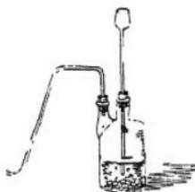
Die Darstellung geschieht in demselben Apparat (Fig. 70), welcher zur Entwicklung von Wasserstoffgas angewendet wird. Auf den Boden der Flasche bringt man Kupferdrehspäne, bedeckt dieselben mit einer Schicht von Wasser und giesst durch die Trichterröhre allmählig und in kleinen Portionen Salpetersäure zu. Man kann das entweichende Gas entweder über Quecksilber oder über Wasser auffangen; letzteres nimmt  $\frac{1}{20}$  seines Volums davon auf.
