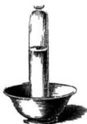
Sauerstoff, und verschwindet rasch; es entsteht ein Oxyd, welches man durch Verdampfen des Wassers in einer Schale erhalten kann. Um diesen Versuch mit Bequemlichkeit anzustellen, füllt man in einer Quecksilberwanne eine Glocke mit Quecksilber (Fig. 15) an, lässt in den oberen Theil der Glocke etwas Wasser aufsteigen und bringt zuletzt ein Stück Kalium hinein, welches man in Fliesspapier einwickelt, damit es sich nicht mit dem Queck-
