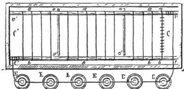
sitiven Pol der Batterie, in Verbindung. Bewegliche Drähte,  $ab$ , von vergoldetem Messing, welche bei  $a$  mit Firniss überzogen sind, verbinden  $rv'$  mit  $tt'$ , und auf sie werden die zu vergoldenden Gegenstände gelegt.
