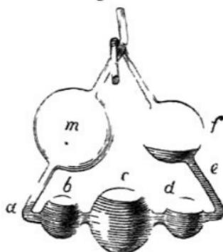
Die bei der Verbrennung entstandene Kohlensäure geht durch das Chlorcalciumrohr und wird von Kalilauge, die in einem Liebig'schen Kugelapparat (Fig. 171) enthalten ist, aufgenommen. Dieser Apparat *B* (Fig. 172) ist durch ein Kautschukrohr mit der Chlorcalciumrohre verbunden; sein Gewicht wird vor und nach dem Versuch bestimmt, und die Gewichtszunahme drückt die Menge der bei der Verbrennung entstandenen Kohlensäure aus.
