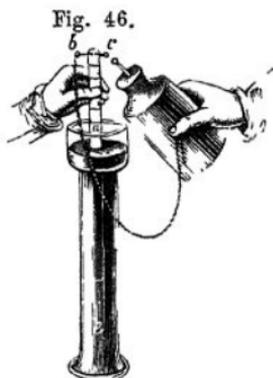
von zwei luftdicht eingeschmolzenen Platindrähten *bc* durchbohrt, welche sich innen fast berühren, und aussen in Oesen endigen. Die eine Oese *b* verbindet man durch eine kleine Kette mit dem äusseren Beleg einer geladenen Leydener Flasche, die andere *c* berührt man mit dem Knopfe der Flasche. Zwischen den beiden Platindrähten springt alsdann ein elektrischer Funke über, welcher das Knallgas entzündet.
