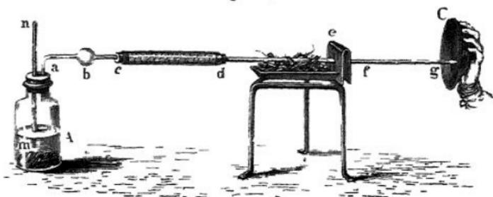
hinter dem Schirm *e* setzt sich das Arsen als Metallspiegel ab. Nimmt man die Kohlen weg und zundet das entweichende Gas bei *g* an, so kann man durch Annähern einer Porzellanschale *C* darauf eine Abscheidung von »Arsenflecken« hervorbringen.
