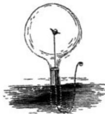
143. Die Zusammensetzung des schwefeligen Gases lässt sich auf synthetischem Wege leicht ermitteln. Man füllt einen Glasballon (Fig. 78) mit Sauerstoffgas über Quecksilber an, fuhr mittelst eines gebogenen Eisendrahts eine kleine Schale mit einem
