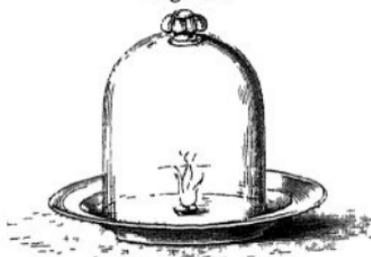
und lässt einige Stunden lang ein paar Stücke gebrannten Kalk auf einer Porcellanschale in der Glocke stehen, wodurch der Luft die Feuchtigkeit entzogen wird. Man nimmt hierauf die Schale aus der Glocke und setzt an ihre Stelle ein Schälchen, mit einem Stück brennendem Phosphor. Die Verbrennung hält
