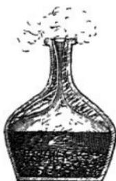
mit dem Russ viel Salmiak aus, welcher gesammelt und in Fabriken gereinigt wird, indem man den Russ in grossen gläsernen Ballons (Fig. 132) erhitzt; der Salmiak verdampft hierbei und verdichtet sich in dem oberen Theil des Ballons.
