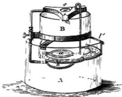
gewöhnlich benutzten kleinen Apparat dar: *A* ist ein mit einer gesättigten Kupfervitriolösung gefülltes Glasgefäß; damit trotz der Abscheidung des Kupfers die Lösung fortwährend gesättigt bleibe, bringt man auf die Unterlage *m* Krystalle von Kupfervitriol. Ein an beiden Enden offener Glaszylinder *B* wird durch die Stützen *l*, *l'*, *l''* in dem Inneren des Gefäßes *A* erhalten;
