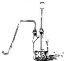
die eine Oeffnung der Flasche geht eine Gasleitungsröhre, welche das Gas in eine pneumatische Wanne führt, die andere Oeffnung ist durch ein Glasrohr verschlossen, welches oben sich trichterförmig erweitert und bis fast auf den Boden der Flasche reicht. Durch den Trichter gießt man Wasser in die Flasche, bis diese zur Hälfte damit angefüllt ist, und bringt hierauf durch dieselbe Röhre Schwefelsäure in kleiner Menge hinzu. Sobald die Säure mit dem Zink in Berührung kommt,
