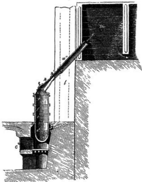
bringt sie in den eisernen Kessel *d*, setzt mehrere eiserne Ringe *e, f, g, h* auf und verbindet den letzten Theil mittelst der eisernen Röhren *n, n', n''* mit den Condensationskammern *m*. Beim Erhitzen verflüchtigt sich die arsenige Säure, und setzt sich an den eisernen Ringen in glasartigen Krusten ab.
