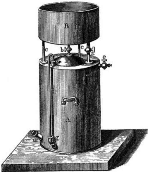
Gasleitungsröhre aus dem Cylinder heraus und schliesst die Schraube bei *d*. Das Gas lässt sich in dem Gasometer so lange aufbewahren, als man irgend will.
