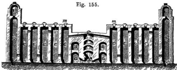
des in Idria angewendeten Ofens. Die Erze werden auf die durchbrochenen Gewölbe *B, B, B* gebracht, wo sie von der überschüssiges Sauerstoffgas enthaltenden Flamme des auf dem Rost *A* entzündeten Brennmaterials erhitzt werden. Die Quecksilberdampfe gehen mit den Verbrennungsgasen in die Reihe von
