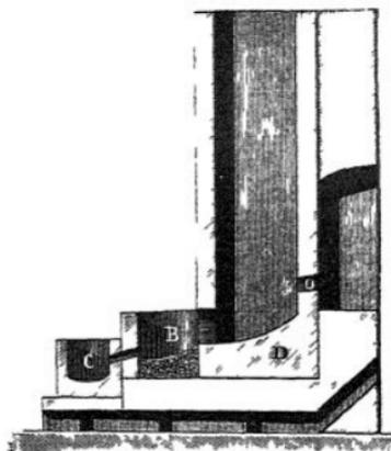
A ist mit einem Vortiegel B versehen, von dessen tiefster Stelle ein Canal in den Kessel C (Stickheerd) führt. An der Seite des Schachtes befindet sich die Formöffnung *o* zum Einbringen des Geblases.
