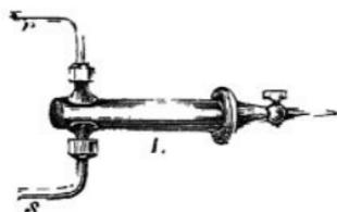
grosse Anzahl runder Scheibchen, aus einem dichten Metallgeflecht geschnitten, über einander liegt. Die messingene Röhre geht vorn in eine Spitze aus, welche einen Aufsatz von Platin erhält. Man öffnet die Hähne *a* der beiden Gasometer, so dass in das Wasserstoffgasometer doppelt soviel Wasser eintritt, als
