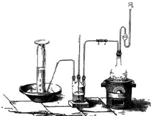
wickelt, welches in eine mit wässrigem Ammoniak zur Hälfte angefüllte Flasche geleitet wird; das Chlorgas verliert darin sogleich seine gelbe Farbe, und in der Flüssigkeit bildet sich eine Menge kleiner Gasblasen von Stickstoff, welche man aufsammt, sobald die atmosphärische Luft vollständig aus dem Apparat verdrängt ist.
