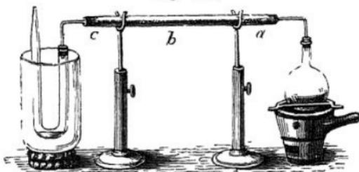
steht; die erste Hälfte  $ab$  dieser Röhre ist mit Marmorstücken, die zweite  $bc$  mit Stücken von geschmolzenem Chlorcalcium gefüllt. An das Ende der Röhre  $abc$  bringt man eine U-förmige Röhre und umgibt sie
