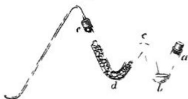
aus einer dreimal gebogenen, an beiden Enden offenen Röhre. *a*, *b*, *c*, *d*, *e*, besteht. Nach *d* bringt man einige Phosphorstücke und füllt den Schenkel *de* mit kleinen Stücken von nassem Glas an; durch die Oeffnung *a* giesst man das Brom ein,
