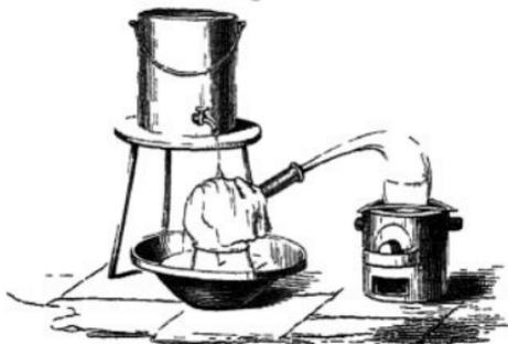
Zusammensetzung des Apparates darf man keinen Kork anbringen, weil die concentrirte Salpetersäure denselben heftig angreift, so dass dieser in dem Dampf der Säure sogar Feuer fangen kann.
