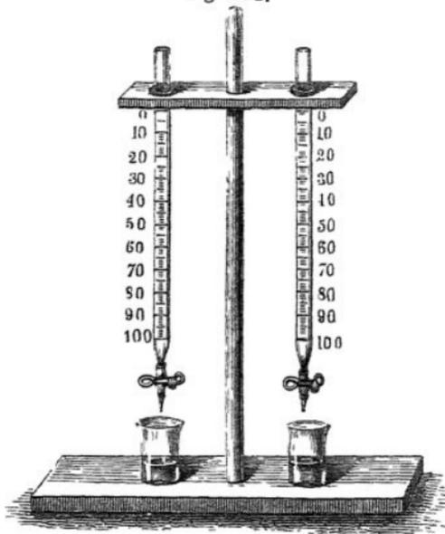
auf die Feder die Einschnürung der Kautschukröhre aufhebt. Man füllt die Burette bis an den oberen Anfang der Theilung (Nullpunkt), lässt die Probesäure langsam zufließen, bis die saure Reaction in der zu prüfenden Flüssigkeit eingetreten ist, und liest unmittelbar die Menge der verbrauchten
