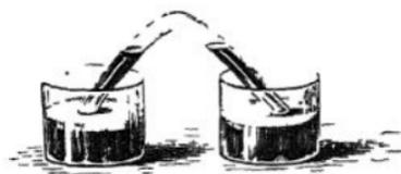
beiden offenen Enden in zwei mit Quecksilber gefüllte Gläser, und lässt in den oberen Theil der U-förmigen Röhre eine gewisse Menge von Luft und etwas Kalilauge treten. Man verbindet hierauf das Quecksilber des einen Glases
