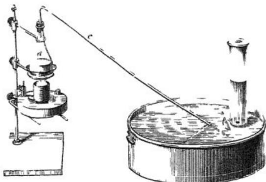
einen Kolben *a*, gießt concentrirte Schwefelsäure darauf, und befestigt an der Mündung des Kolbens mittelst eines Korks eine Gasleitungsröhre, durch welche das Gas in eine mit Wasser gefüllte Wanne geleitet wird, und erhitzt über der Spirituslampe.
