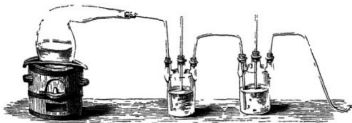
tion sich stark aufbläht, und leitet das Gas zuerst durch eine etwas Wasser enthaltende Waschflasche, hierauf durch eine zweite mit Kalilauge, worin die schwefelige Säure und Kohlensäure zurückgehalten werden. Die Zersetzung geht leichter und ohne Aufblähen vor sich, wenn man die Retorte zum vierten Theil mit Sand füllt.
