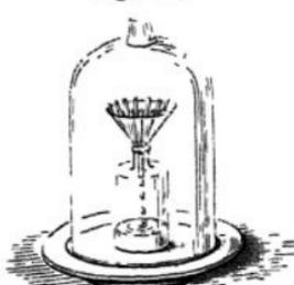
Die Phosphorstangen verbrennen langsam bei gewöhnlicher Temperatur; die hierbei entstehende phosphorige Säure, welche schwerer als die Luft ist, fällt in die Flasche hinunter und löst sich darin in dem Wasser auf, so dass man nach einigen Tagen eine ziemlich concentrirte Lösung dieser Säure erhält.
