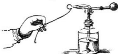
Oese umbiegt. Man taucht diese etwas befeuchtete Oese in gepulverten wasserfreien Borax, und setzt ein wenig von dem zu prüfenden Metalloxyd zu, Löthrohr (Fig. 123), und erhält eine Perle, in welcher das Metalloxyd sich löst; nach dem Erkalten kommt die charakteristische Färbung des Metalloxyds zum Vorschein.
