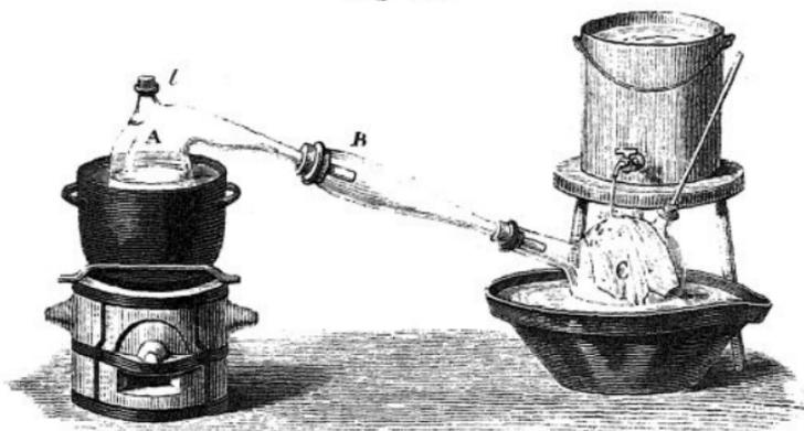
torte wird im Wasserbad erwärmt, indem man sie in einen kleinen mit Wasser gefüllten und über Kohlen erhitzten Kessel stellt. Die Zersetzung ist übrigens genau dieselbe wie beim Chlor; es entsteht schwefelsaures Natron und schwefelsaures Manganoxydul, welche in der Retorte bleiben, während das Brom sich verflüchtigt und in der Vorlage wieder verdichtet. Das Brom ist bis jetzt noch zu theuer, als dass man von ihm in den Gewerben eine irgend bedeutende Anwendung hätte machen können.
