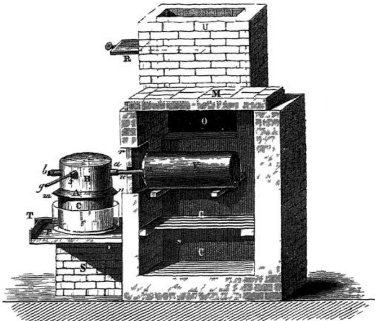
saure Kali zu wirken an; aus der Rohre *y* entweicht eine ansehnliche Menge von Kohlenoxydgas, und das freiwerdende Kalium verfluchtigt sich und fallt in Tropfen in die Vorlage nieder. Die Vorlage besitzt eine eigenthumliche Einrichtung. Sie besteht aus zwei kocherformig in einander passenden Theilen (Fig. 119).
