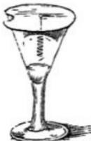
Giesst man in ein Standglas wenig Aether (Fig. 167), und bringt eine vorher zum Rothglühen erhitzte Platinspirale hinein, die an einem das Glas unvollständig schliessenden Pappendeckel befestigt ist, so bleibt diese Spirale während langer Zeit glühend. Die Alkohol- und Aetherdämpfe erleiden in diesen Versuchen nur eine unvollständige Verbrennung und verwandeln sich hierbei in flüchtige Producte von saurem und erstickendem Geruch.
