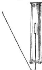
Häufig hat man nothwendig trockne Gase anzuwenden, und darf sie daher nicht über Wasser, sondern über Quecksilber auffangen, welches in einer, aus Marmor oder einem anderen dichten Stein gefertigten, Wanne enthalten ist. Kleinere Quecksilberwannen macht man von Porcellan oder Eisen. Man giebt
