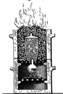
als eines mit Phosphor gefüllten Kolbchens passt. Der Tiegel wird in der Weise auf den Rost gestellt, dass das Kolbchen mit Phosphor sich unterhalb des Rostes befindet. Man erhitzt denselben zum lebhaften Rothgluhen und legt hierauf unter das Kolbchen einige Kohlen, so dass der Phosphor langsam destilliert. Die Phosphordämpfe verbinden sich dann in dem Tiegel mit dem Kalk.
