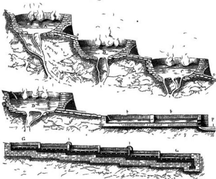
Wasser erhält. Nachdem sich die borsäurehaltige Lauge in den Reservoirs *E, F* geklärt hat, leitet man sie in die Pfannen *G, G*, woselbst sie durch Dampfstrahlen erhitzt allmählig concentrirt wird. Beim Abkühlen der Losung scheidet sich Borsäure in farblosen Krystallen aus, gemengt mit vielen anderen Salzen, die man durch wiederholte Krystallisation trennt.
