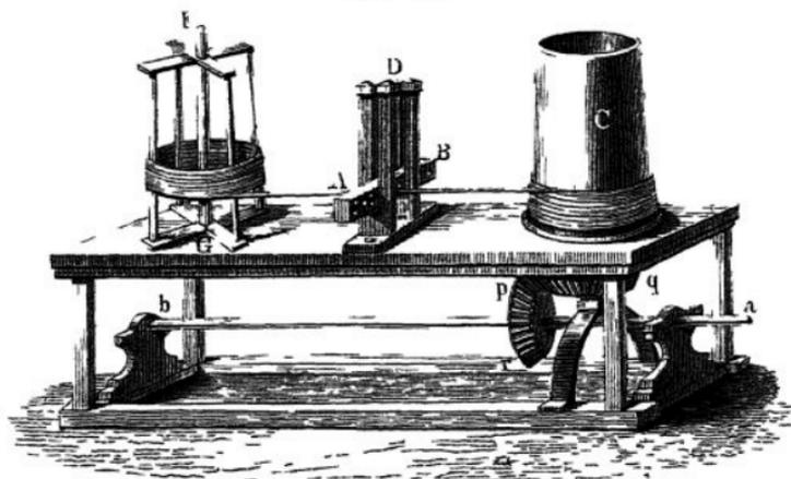
Vorrichtung dar. Der ausgegluhte Metallstab wird um den Haspel *FG* gelegt; sein verdünntes Ende steckt man durch das grösste Loch des Zieheisens *AB* und befestigt es hierauf auf der Trommel *C*, welche letztere durch die Räder *p, q* mit der Triebwelle in Verbindung steht. Hat der Draht das erste und grösste Loch passirt, wodurch er dünner und länger geworden ist, so zieht man ihn durch stets engere Locher des Zieheisens bis er die gewünschte Dicke erhalten hat.
