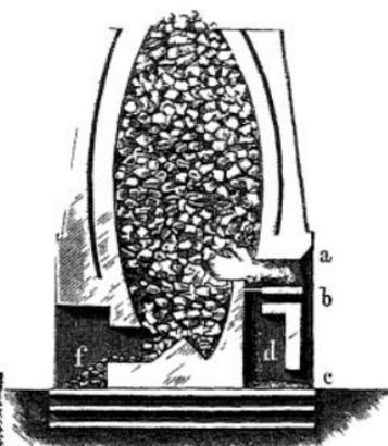
Er zeigt einen eiförmigen Feuerraum, der mit feuerfesten Backsteinen ausgemauert ist. Ueber dem Roste oder der Sohle des Ofens baut man zuerst mit den grossten Kalksteinen eine Art Gewölbe, welches die ganze Füllung des Ofens, die man von oben einbringt, zu tragen hat. Ist der Ofen gefüllt, so zundet man unten zuerst Reissig an, später wendet man kräftigeres Brennmaterial an, und unterhält das Feuer etwa 12 Stunden lang, worauf man erkalten lässt und den gebrannten Kalk herausnimmt.
