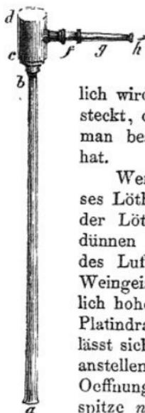
cylindrischen Behälter *cd* befestigt, welcher gleichzeitig als Windkasten und zur Ansammlung der, durch den Luftstrom mitgerissenen Feuchtigkeit dient. Seitlich befindet sich an dem Cylinder ein kleines Ansatzrohr *f*, in welches die Spitze *g* eingerieben ist. Gewöhnlich wird darüber ein kleiner Aufsatz *h* von Platingesteckt, der je nach der Stärke des Luftstromes, die man beabsichtigt, eine engere oder weitere Oeffnung hat.
