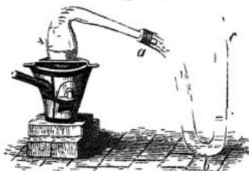
Innere der Retorte mit der äusseren Luft nicht in Verbindung steht und auch der überdestillirte Phosphor von der Berührung mit der Luft abgeschnitten ist. Erhitzt man die Retorte, so dehnt sich die Luft aus, drückt das Wasser in dem einen Schenkel der U-förmigen Röhre herunter und
