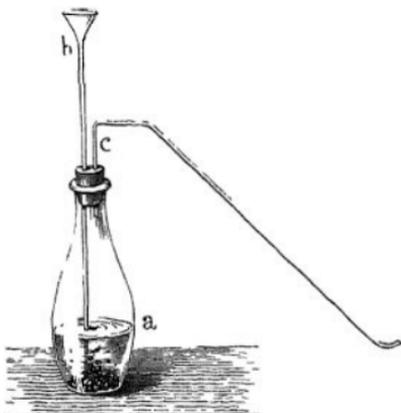
Man bedient sich hierzu eines ähnlichen Apparates, wie zur Entwicklung des Wasserstoffgases. Eine Glasflasche *a* (Fig. 57), in welcher man einige Stücke von Schwefeleisen mit etwas Wasser übergossen hat, ist mit einem doppelt durchbohrten Kork verschlossen, durch welchen eine Gasleitungsröhre *c* und ein Trichterrohr *b* gehen. Durch den Trichter gießt man allmählig Schwefelsäure zu. Man kann statt der Schwefelsäure auch Chlorwasser-
