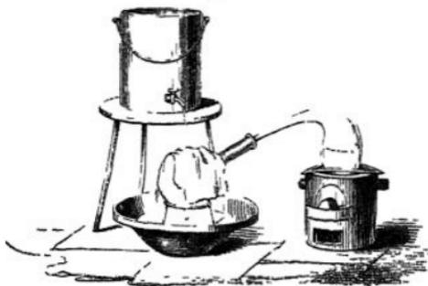
Hals in eine Vorlage mit weiter Mundung tief hineinreicht, welche durch auffliessendes Wasser kalt gehalten wird. Beim Erhitzen geht die Chlorwasserstoffsäure mit Wasser über und verdichtet sich in der Vorlage; es ist indessen gut, etwas Kochsalz zu der rohen Säure zu setzen, wo-
