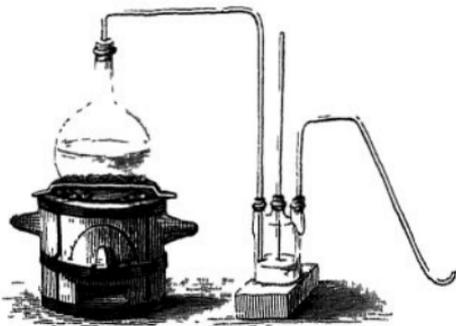
oder über der Spirituslampe. Gewöhnlich leitet man das Gas zuerst durch eine etwas Wasser enthaltende Waschflasche, worin der Dampf der Schwefelsäure zurückgehalten wird. Will man ganz reine schwefelige Säure haben, so muss man noch ein mit Chlorcalcium gefülltes Rohr
