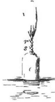
Sauerstoff in die Blase. Reicht die in der Glocke befindliche Gasmenge zur Füllung der Blase nicht hin, so schliesst man die Hähne, füllt die Glocke nochmals mit Sauerstoffgas an, und lasst nach abermaligem Oeffnen der Hähne eine neue Menge von Sauerstoffgas in die Blase eintreten. Das Metallstück *r* wird hierauf abgeschraubt, alsdann eine feine Rohre *t*, Fig. 14,
