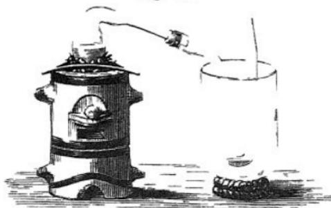
139. Die Untersalpetersäure ist eine orangefarbene Flüssigkeit von 1,42 specif. Gewicht; sie siedet bei  $+ 20^{\circ}$ , und entwickelt dabei intensiv roth getarbte Dämpfe, die eine Dichtigkeit von 1,72 besitzen.
