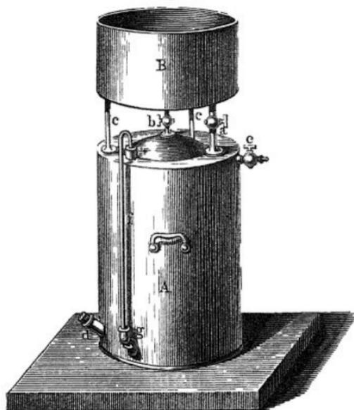
oder auch von Zink verfertigt, und besteht aus einem cylindrischen Gefäss *A*, und einem kleineren, oben offenen Cylinder *B*, welcher durch vier Stützen *c, c, a, b* getragen wird, von welchen zwei, nämlich *a* und *b* hohl und mit Hähnen versehen sind. Die Rohre *b* mündet in dem Gefässe *A* unmittelbar an der oberen Wand, die Rohre *a* geht dagegen bis nahe an den Boden des Cylinders. Bei *e* befindet sich eine
