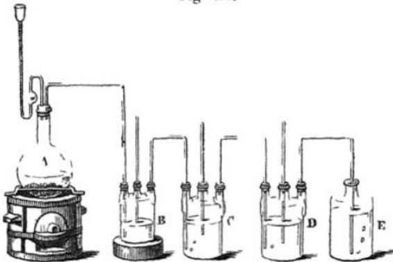
sten Flasche nicht aufgenommene Gas geht durch das Wasser in der zweiten Flasche, und so fort. Die erste Flasche B dient zur Wegnahme von mitgerissener Chlorwasserstoffsäure und enthält daher nur wenig Wasser. Einen derartigen Absorptionsapparat nennt man einen Woulff'schen Apparat.
