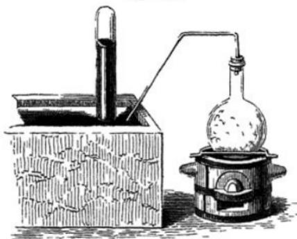
Wenn gegen das Ende des Versuchs die Temperatur bedeutend steigt, so kann ein Theil des entstandenen Wassers mit dem Ammoniakgas entweichen; will man daher viel trocknes Ammoniakgas entwickeln, so muss man dasselbe durch eine mit Stücken von geschmolzenem Kalihydrat gefüllte Rohre streichen lassen, worin alles Wasser zurückbehalten wird. Man
