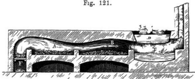
zuerst den Raum *A*, hierauf den Raum *B* erhitzt, und endlich durch *C* in den Schornstein *O* geht. In *B* wird das Gemenge von schwefelsaurem Natron, kohlen-saurem Kalk und Kohle vorgewärmt, und später nach *A* gebracht, woselbst die chemische Zersetzung sich vollendet. Man benutzt gleichzeitig einen Theil der sonst nutzlos entweichenden Wärme, um im dem Kessel *D* die Sodalaugé einzuengen, worauf sie in dem unteren Raum *C* eine weitere Concentration erleidet.
