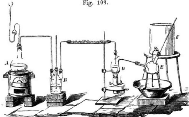
ser gefüllten Flasche *B* gewaschen, und hierauf in der folgenden mit Chlorcalcium gefüllten Rohre getrocknet.
