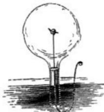
darin mittelst einer starken Linse oder eines Brennspiegels an. Die Kohle verbrennt darin zu Kohlensäure, und nach beendigter Verbrennung und dem Erkalten des Apparates auf die anfängliche Temperatur findet man das Volum des Gases nicht merklich verändert. Es folgt hieraus, dass die Kohlensäure ein ihrem eigenen Volum gleiches Volum Sauerstoff enthält.
