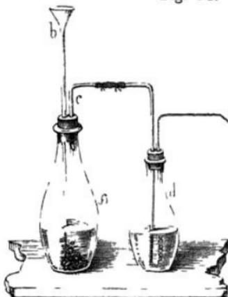
Kalkstein oder Marmor mit wenig Wasser in eine Entwicklungsflasche (Fig. 94), schüttelt etwas, um die an dem Kalksteine haftenden Luftblasen zu entfernen, und giesst durch den Trichter Chlorwasserstoffsäure ein. Sobald diese Säure mit dem Kalksteine in Berührung kommt, entsteht ein
