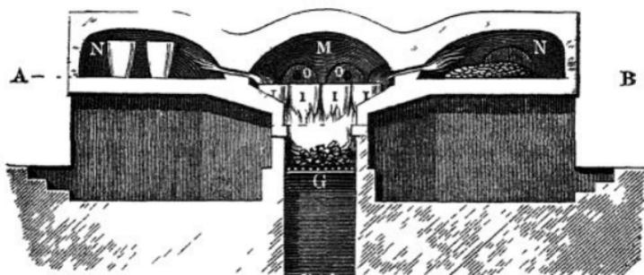
giebt den Durchschnitt eines Glasotens und Fig. 139 den Grundriss desselben nach der Linie *AB*. Man sieht, wie die Flamme
