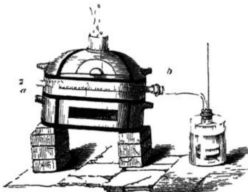
wird durch einen Kork verschlossen; es steht so weit aus dem Ofen hervor, dass der Kork nicht anbrennen kann; das andere Ende *b* ist mit einem gebogenen Vorstoss versehen, dessen Spitze ganz wenig unter die Oberfläche des vorgeschlagenen Wassers taucht. Nachdem die Rohre zum Gluhen erhitzt ist,
