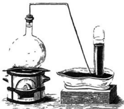
Das Ende der gekrümmten Röhre führt man unter eine mit Quecksilber gefüllte, in einer Quecksilberwanne \*) stehende Glasglocke und erhitzt den Kolben. Wenn die Temperatur des Wassers sich  $40 - 50^\circ$  nähert, so sieht man zahlreiche Gasblasen an der Wand des Kolbens auftreten. Man erhöht die Temperatur des Wassers, bis es kocht, unterhält das Kochen einige Minuten
