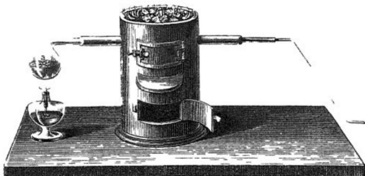
Flintenlauf), welches mit Bündeln von feinem Eisendraht angefüllt ist. Man verbindet eine kleine mit Wasser gefüllte Retorte *a* mit dem einen Rohrende, und befestigt in dem anderen Ende der Rohre luftdicht ein Gasleitungsrohr, welches das Gas unter eine mit Wasser gefüllte Glocke leitet. Die Porcellanrohre wird nun langsam erhitzt, damit sie nicht in Folge zu schneller Temperaturerhöhung springe, und zuletzt bis zur Rothgluth gebracht.
