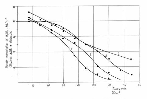
Fig. 4. Diluate concentration  $H_2SO_4$  versus time at different fluxes I = 100 cm/h, 2 = 250 cm/h, 3 = 500 cm/h, 4 = 750 cm/hRys. 4. Zależność stężenia  $H_2SO_4$  w dializacie od czasu przy różnych natężeniach przepływu
