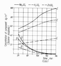
Fig. 6. Concentrate (C) and diluate (D) concentration versus time at current density  $i = 1000 \text{ A/m}^2$ Rys. 6. Zależność stężenia składników w dializacie (D) i koncentracie (C) od czasu przy gęstości prądu  $i = 1000 \text{ A/m}^2$
