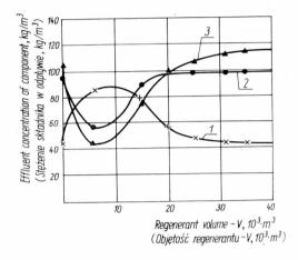
Fig. 3. Regeneration curves for solution 2:  $1 - \text{ZnSO}_4, 2 - \text{H}_2\text{SO}_4, 3 - \text{Na}_2\text{SO}_4$ Rys. 3. Przebieg krzywych regeneracji podczas desorpcji roztworem 2
