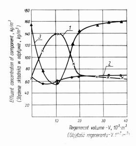
Fig. 2. Regeneration curves for solution 1:  $1 - \text{ZnSO}_4$ ,  $2 - \text{H}_2\text{SO}_4$ ,  $3 - \text{Na}_2\text{SO}_4$ Rys. 2. Przebieg krzywych regeneracji podczas desorpcji roztworem 1
