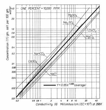
Fig. 2. Concentration of single-salt solutions in percent as related to electrical conductivity Rys. 2. Procentowe stężenie roztworów pojedynczych soli w zależności od przewodnictwa elektrycznego
