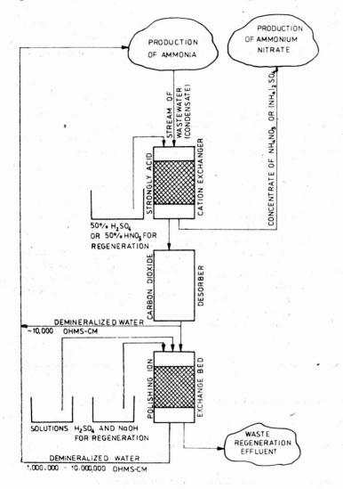
Fig. 5. Recycling of ammonia and water from wastewater of ammonia processing to technological process by ion exchange method Rys. 5. Jonitowa metoda zawracania amoniaku i wo dy ze ścieków z produkcji amoniaku do procesu technologicznego
