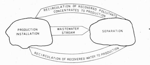
Fig. 1. Full recycling of wastewater constituents to technological process Rys. 1. Pełna recyrkulacja składników ściekowych do procesu technologicznego
