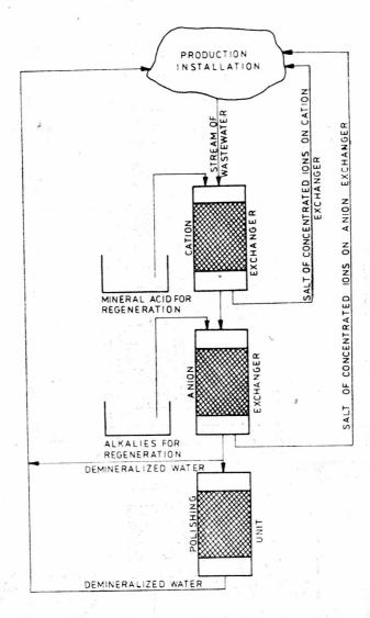
Fig. 3. Recycling of all wastewater constituents to technological process by ion-exchange method Rys. 3. Jonitowa metoda recyrkulacji wszystkich składników ściekowych do procesu technologicznego
