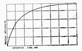
Fig. 1. Kinetics of wastewater sedimentation Rys. 1. Kinetyka sedymentacji ścieków
