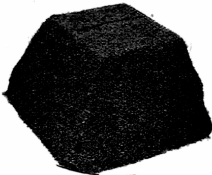
Rys. 24. Zanieczyszczenie piasku w filtrze Nr 2 po 267 dniach działania (warstwa druga).
