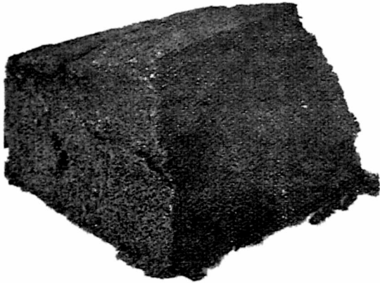
Rys. 22. Zanieczyszczenie piasku w filtrze Nr. 8 po 261 dniach działania
