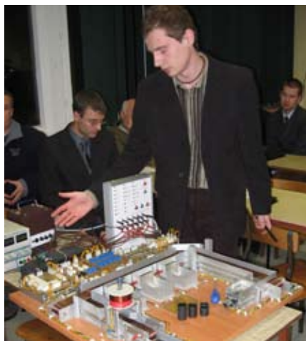
Autor pracy inż. Marek Gołda prezentuje swoje stanowisko laboratoryjne do sortowania przykładowych przedmiotów wykonane z zastosowaniem sterowników programowalnych.
