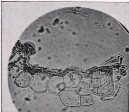
Abbildung 27. Schnitt durch eine Flachsfaser.
