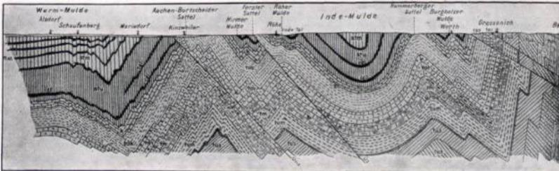
Abbild. 10. Querschnitt durch das Aachener Steinkohlengebiet (nach Holzapfel).
