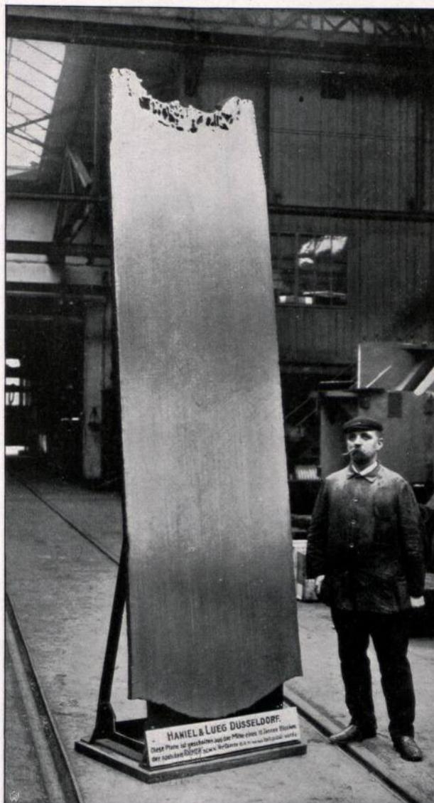
Abbildung 34. Firma Haniel & Lueg in Düsseldorf-Grafenberg: Durchschnittener Stahlblock nach dem Riemerschen Verfahren behandelt.
