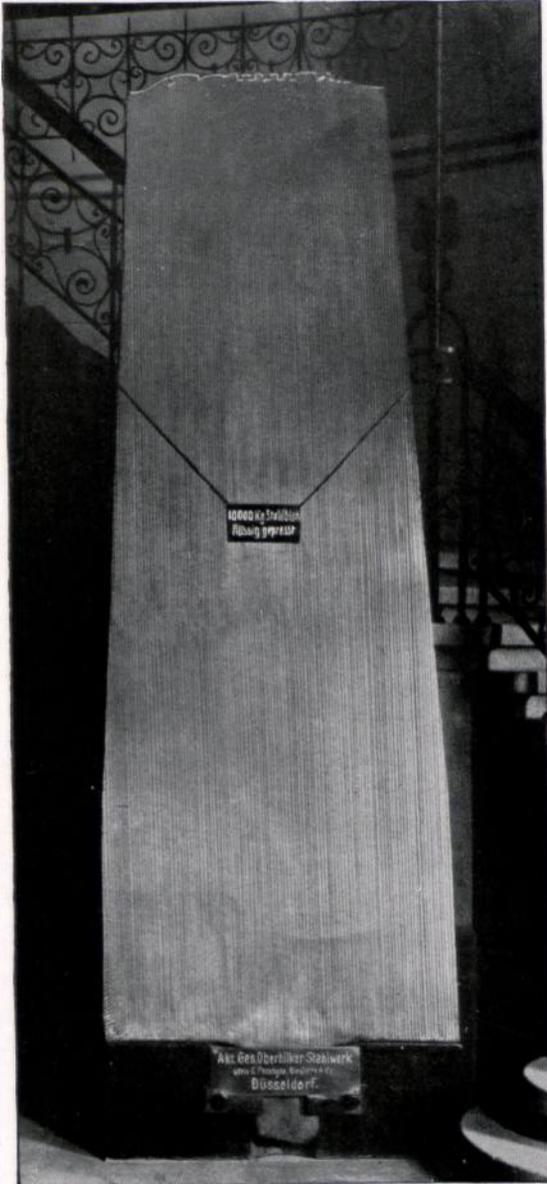
Abbildung 37. Akt.-Ges. Oberbilker Stahlwerk in Düsseldorf-Oberbilk: Durchschnittener Stahlblock nach dem Verfahren von Harmet hergestellt.
