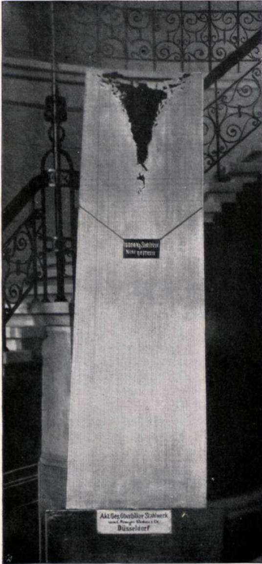
Abbildung 33. Akt.-Ges. Oberbiller Stahlwerk in Düsseldorf-Oberbilk: Durchschnittener Stahlblock mit Lunker. Hergestellt ohne Anwendung eines Verdichtungsverfahrens.
