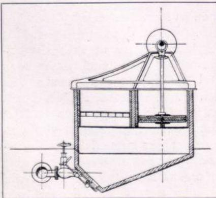
Abbild. 73. Setzmaschine im Querschnitt.
