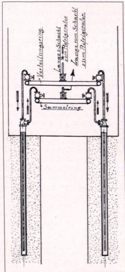
Abbildung 17. Anordnung der Rohrleitungen beim Gefrierschachtverfahren.
