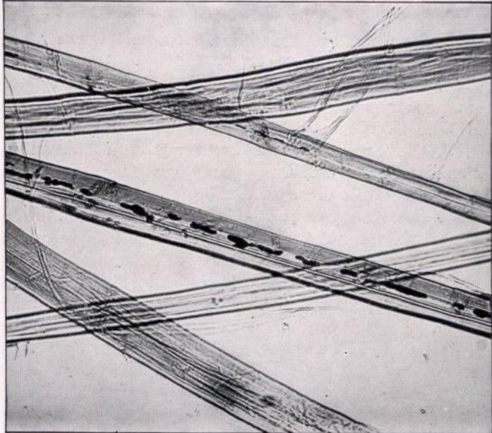
Abbildung 33. Einzelzelle der Ramiefaser.
