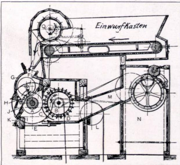
Abbildung 10. Säge-Entkörnungsmaschine.
