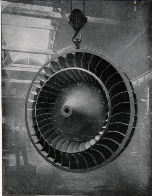
Abbildung 49. Schleuderrad eines großen Grubenventilators.
