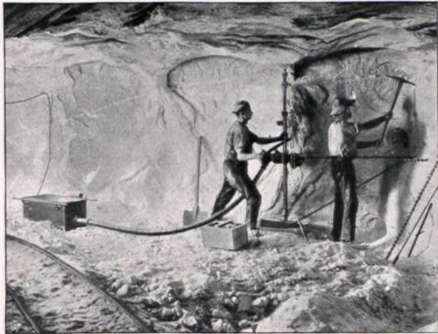
Abbild. 96. Bergemühle im älteren Steinsalz bei Staßfurt mit elektrischer Bohrmaschine. (Nach Phot. des Kalisyndikats.)
