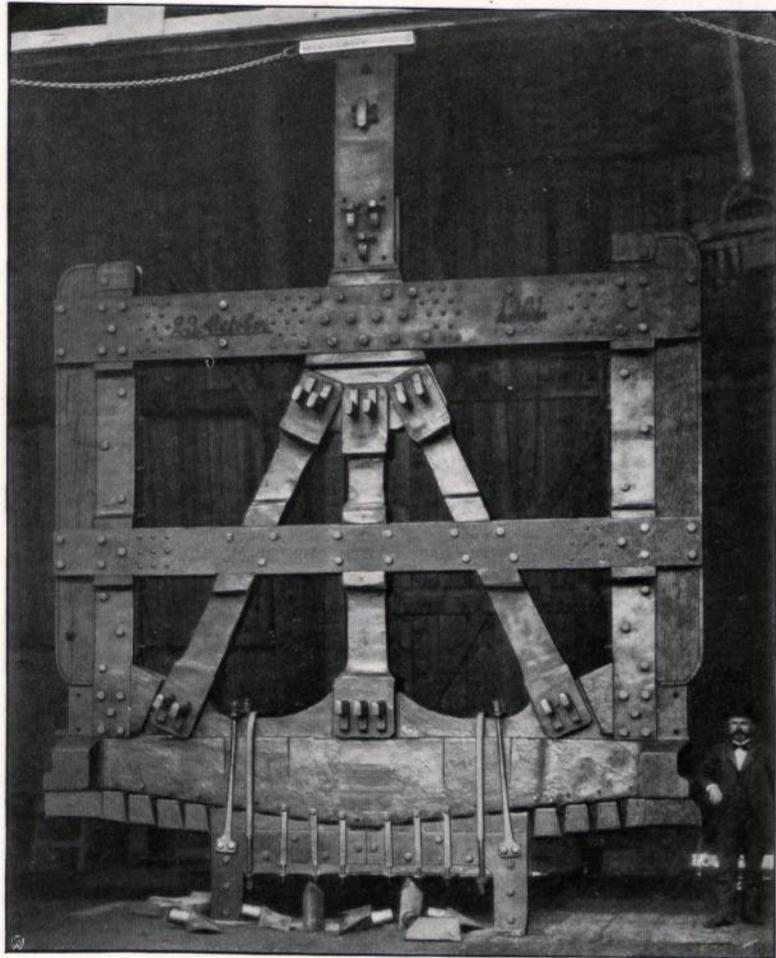
Abbildung 39. Großer Schachtbohrer beim Kind-Chaudron'schen Verfahren.
