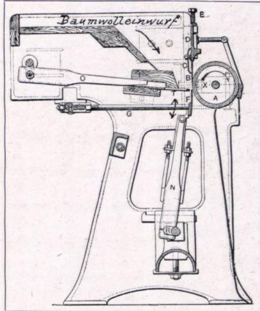
Abbildung 9. Plattentekörnungsmaschine.
