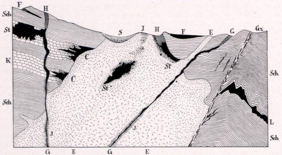
Abbildung 1. Schematisches Bild eines senkrechten Durchchnitts durch ein erzreiches Gebirge. Sch Schiefer, K Kalksteine, E Eruptivgestein, St Erzstock innerhalb von E und von K, J Erz, eingesprengt innerhalb von E und K, C kontakt-metamorphe Erzstöcke und Imprägnationen, G Erzgänge, Gz gangähnliche Zerrüttungszone, L Erzlager, J Erz, S Erzseife, H Hutbildungen an St und G, F Erzflöze. Die Dicke der Gänge stark übertrieben.
