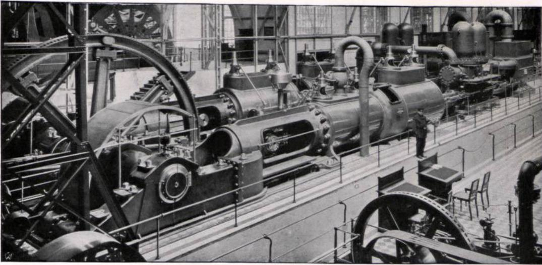
Abbildung 53. Neuzeitliche große Dampfwasserhaltungsmaschine. Zeche Gneisenau bei Dortmund.
