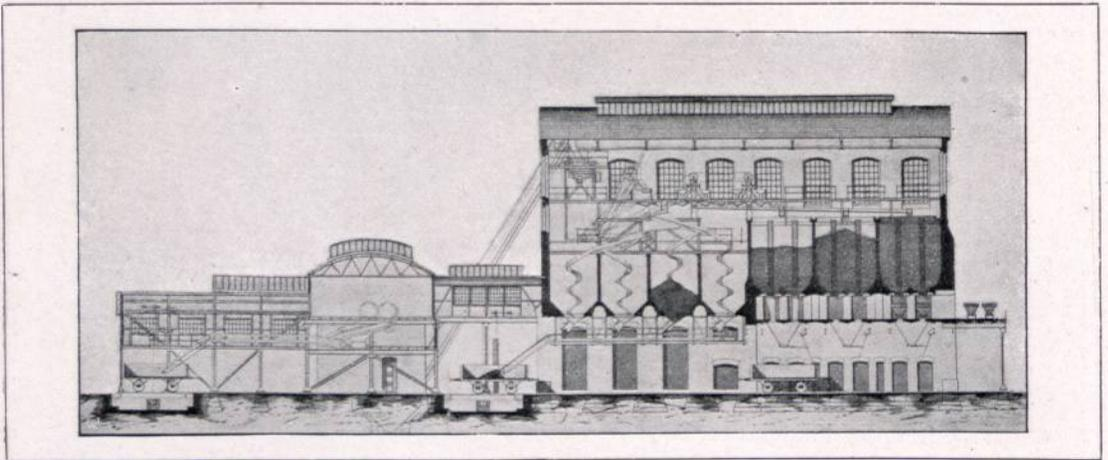
Abbildung 72. Steinkohlen-Aufbereitungsanlage der Zeche Monopol bei Camen. Links Grubenwagenwipper und Leseband; rechts Kohlenwäsche, oben Setzmaschinen, in der Mitte Vorratsbehälter, unten Verladung.
