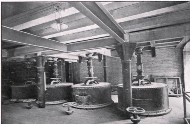
Abbildung 100. Kainitmühlen auf der Kaligrube Berlepsch bei Staßfurt.
