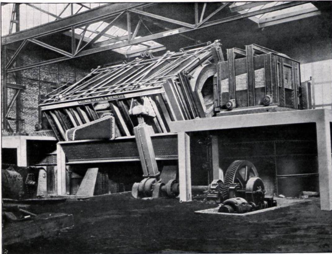
Abbildung 26b. Wellmann Seaver & Head Ltd. in Düsseldorf: Kipbarer Martinofen in Kippstellung.
