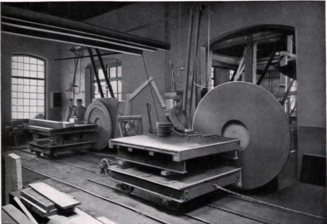
Abbildung 76. Zwei Vertikalabrichtmaschinen im K. Kreuzerschen Granit- und Syenitwerk zu Bensheim.
