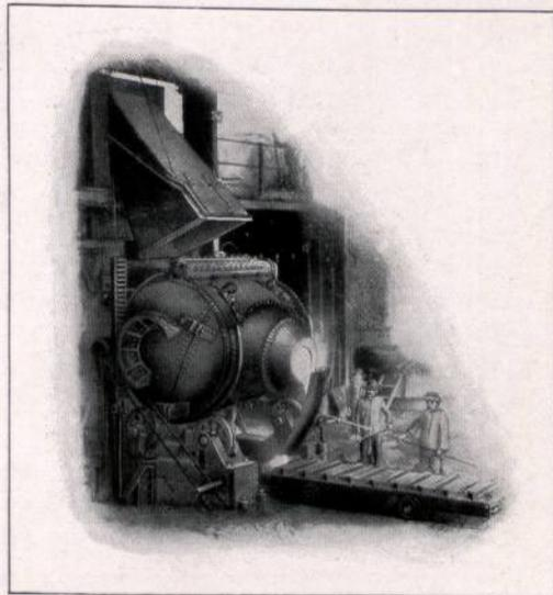
Abbildung 12a. Kupferkonverter beim Ausgießen des Schwarzkupfers.
