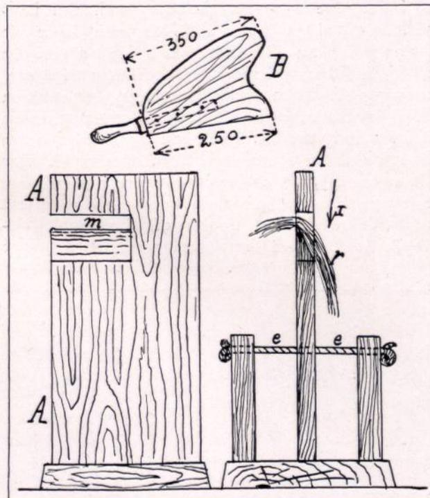
Abbildung 21, 22 u. 23. Handschwingstand mit Schwingbeil.
