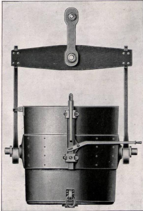
Abbildung 50. Firma Senßenbrenner, Düsseldorf-Obercassel: Gießpfanne für Stahl.
