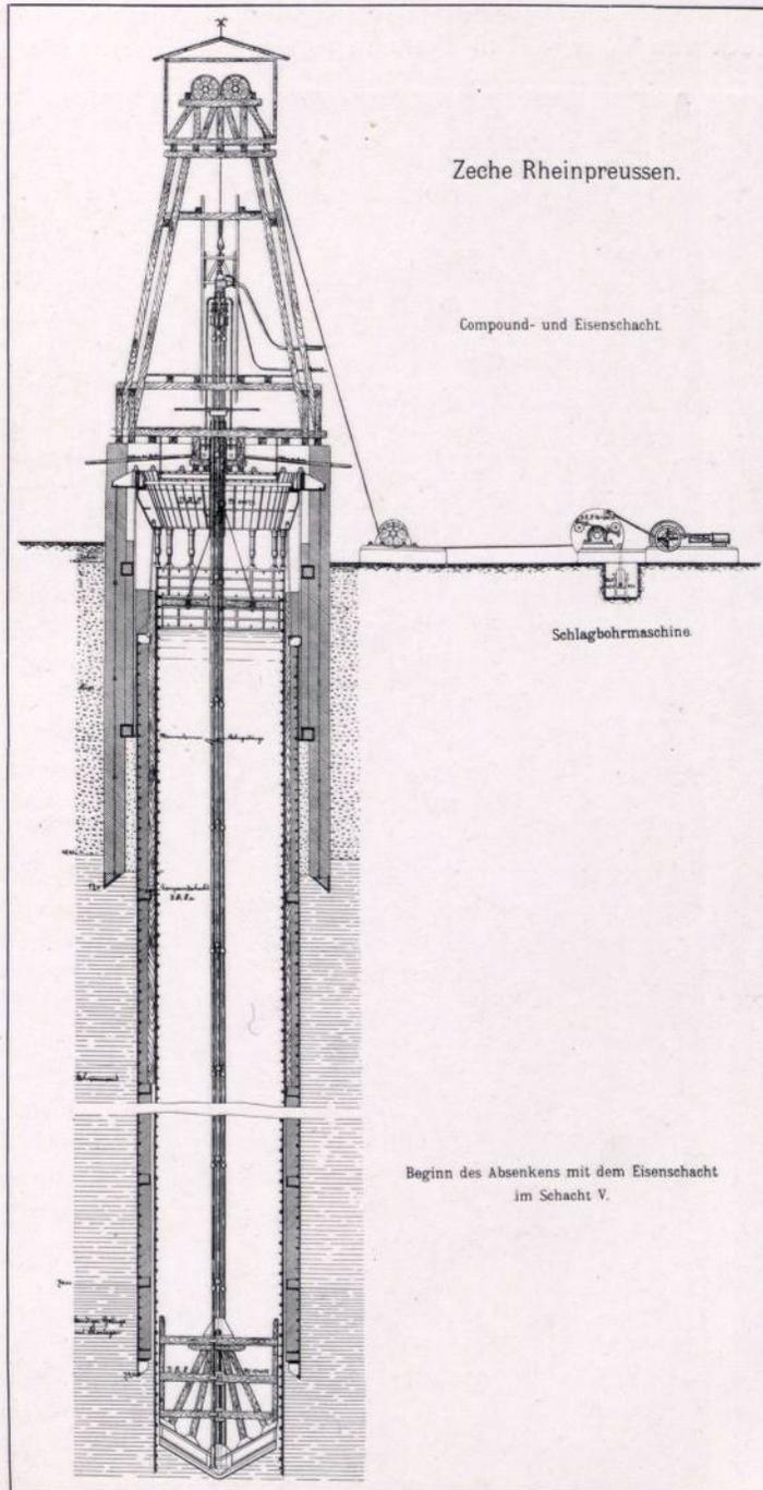
Abbild. 34. Schachtabteufen durch Abbohren und mit Senkschächten.
